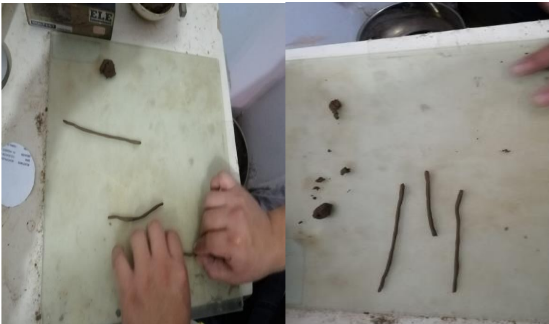
Figura 37. Realización del ensayo de límite plástico (rollito de 3 mm)
