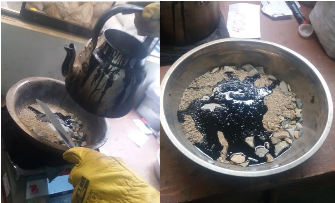
Figura 47. Adición de cemento asfáltico para la elaboración de la briqueta Fuente: elaboración propia.
