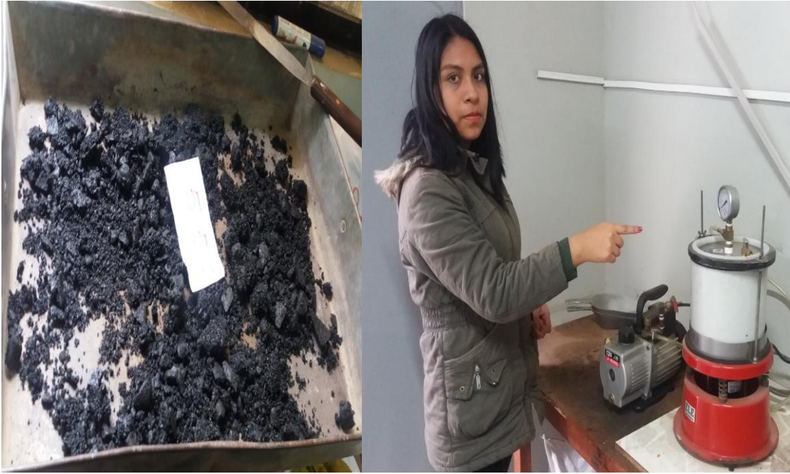
Figura 52. Colocación de la mezcla asfáltica en el equipo Rice
