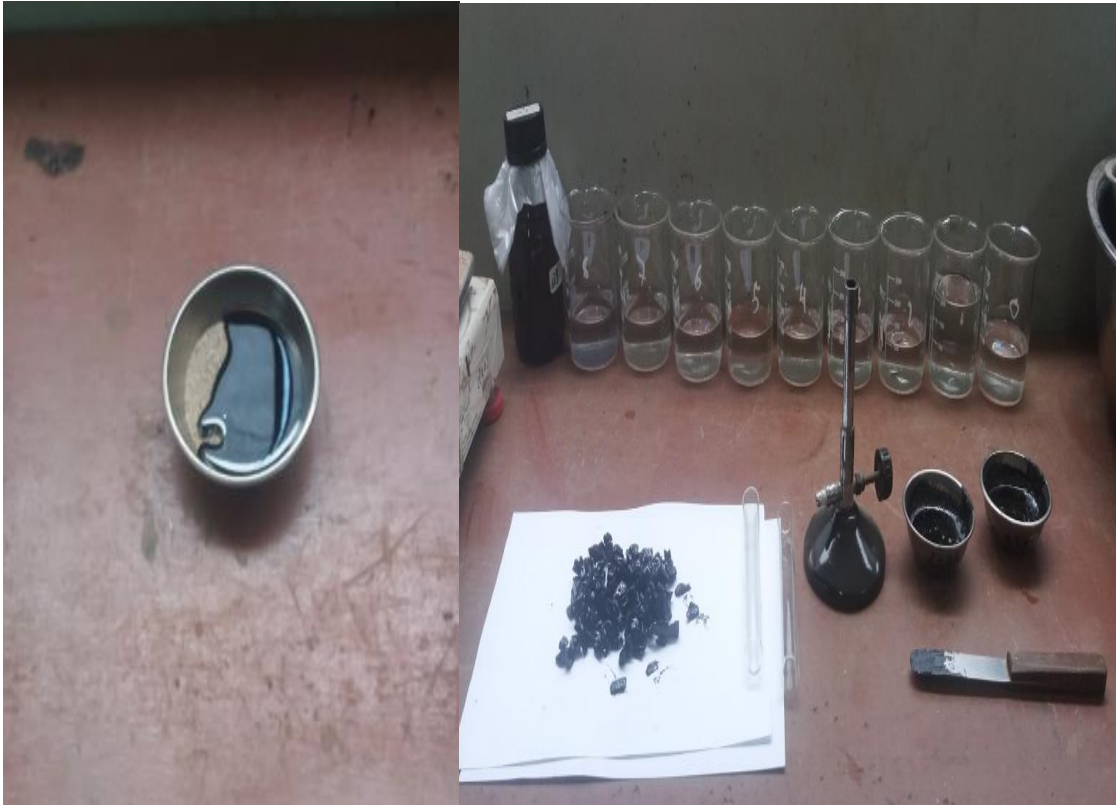
Figura 56. Equipos y materiales para realización del ensayo de Riedel Weber y Stripping Fuente: elaboración propia.
