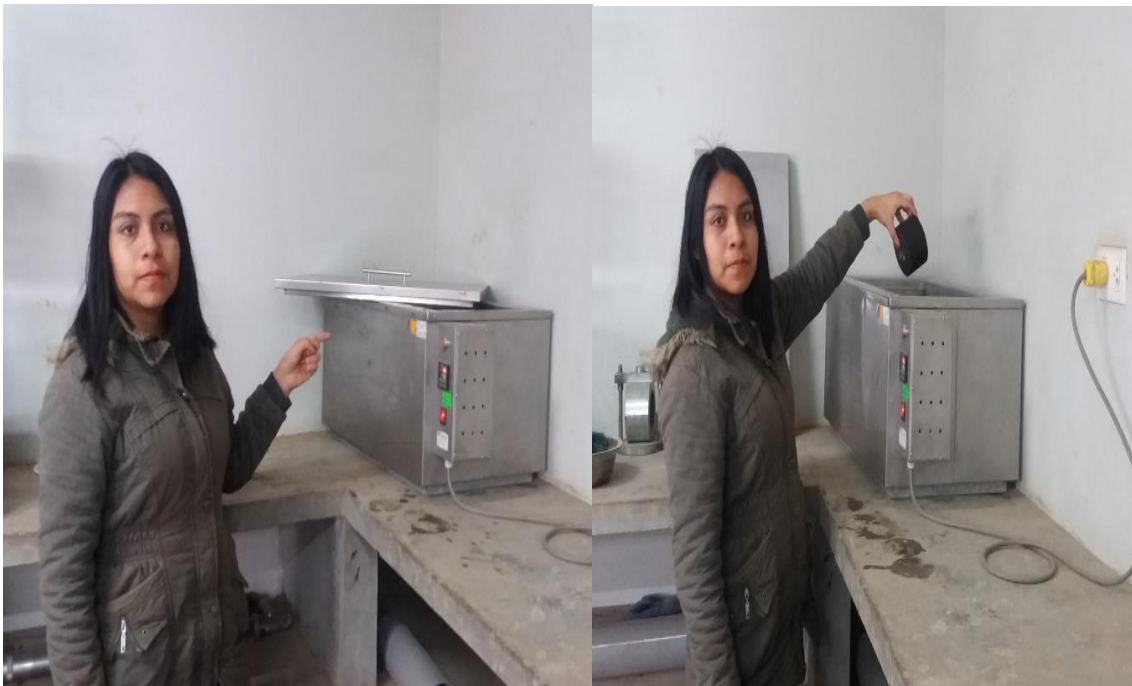
Figura 51. Colocación de las briquetas en baño maría
