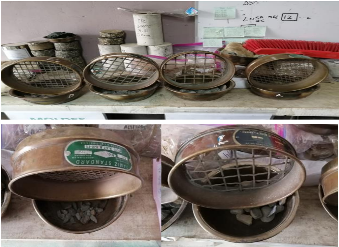
Figura 39. Tamización de los agregados grueso para partículas chatas y alargadas
