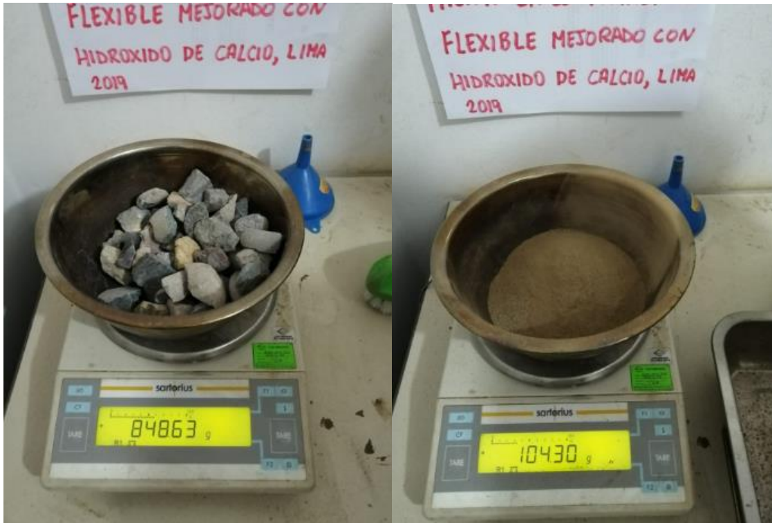
Figura 34. Peso seco del agregado grueso y fino
