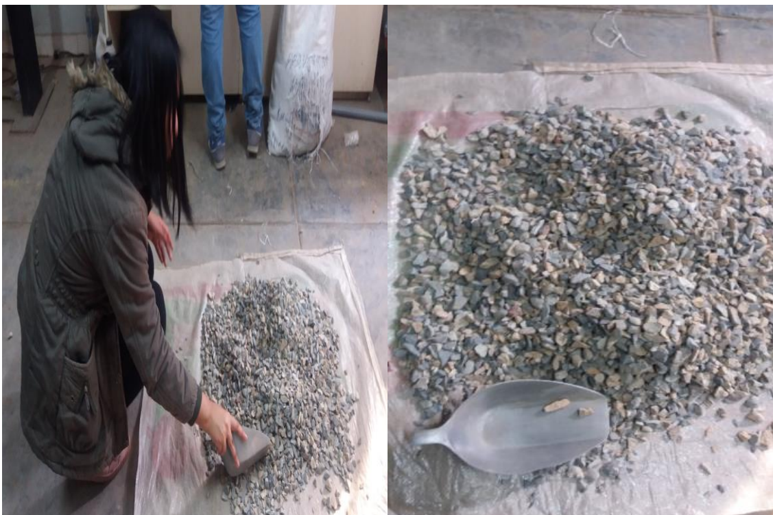
Figura 45. Selección de los agregados gruesos para la realización del diseño de mezcla asfáltica
