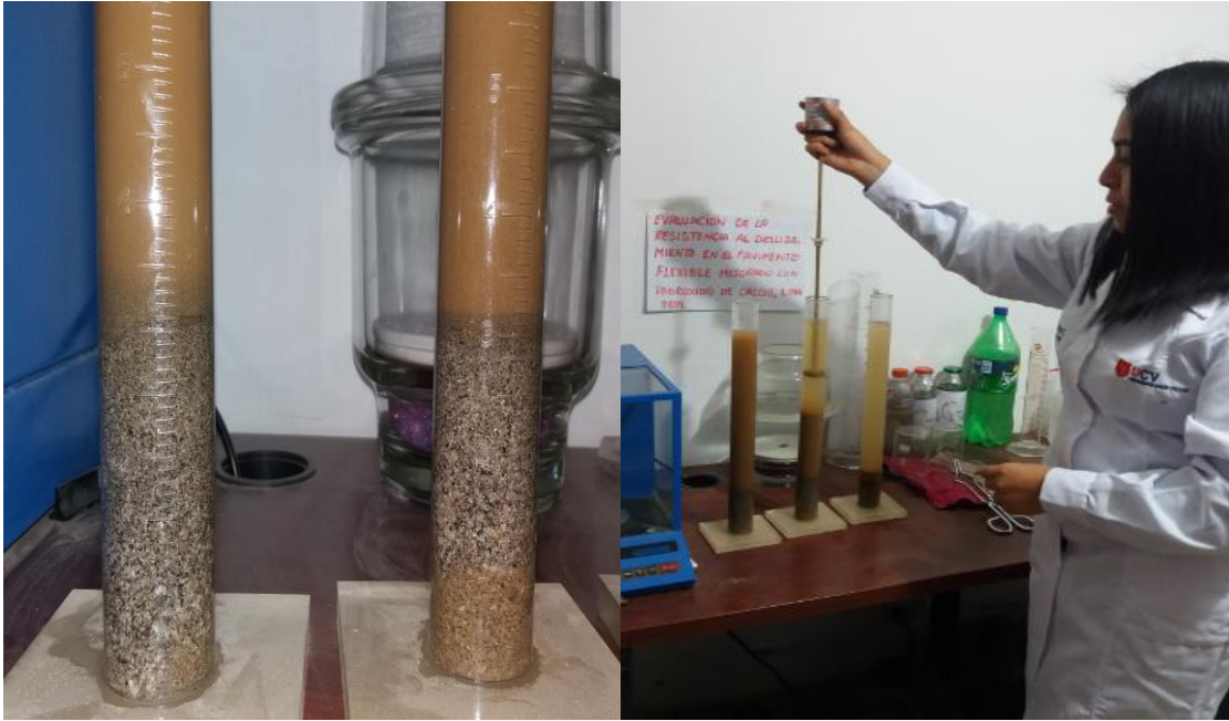
Figura 44. Medición de altura de equivalente de arena
