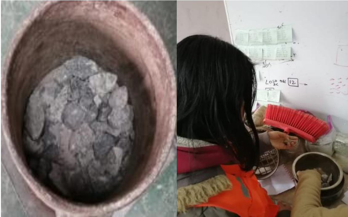
Figura 38. Clasificación en dos grupos de caras fracturadas de cada tamiz
