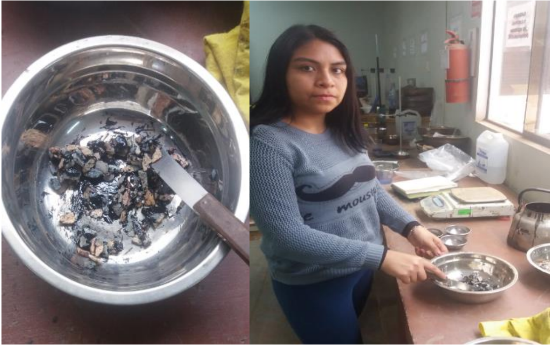
Figura 54. Mezcla del agregado grueso con el cemento asfáltico
