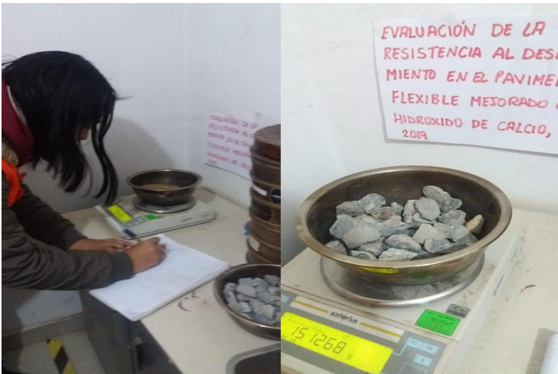
Figura 31. Peso seco de la arena y grava
