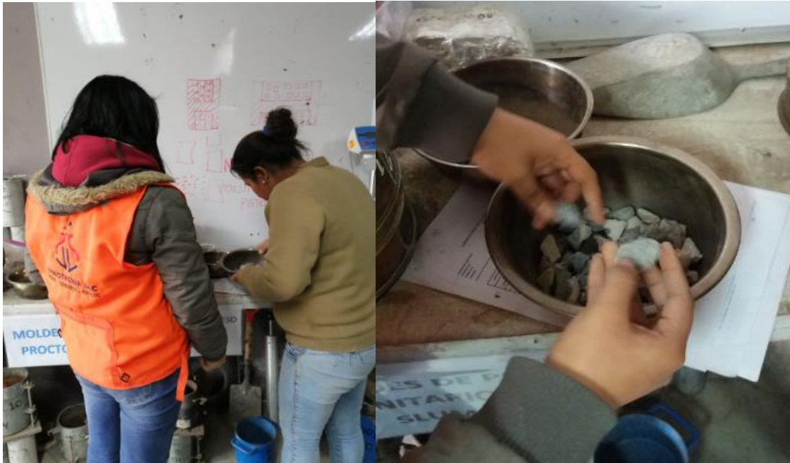
Figura 40. Clasificación de las partículas chatas y alargadas de los agregados gruesos Fuente: elaboración propia.
