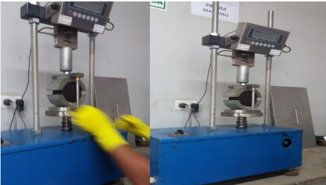
Figura 53. Colocación de las briquetas en el equipo Marshall
