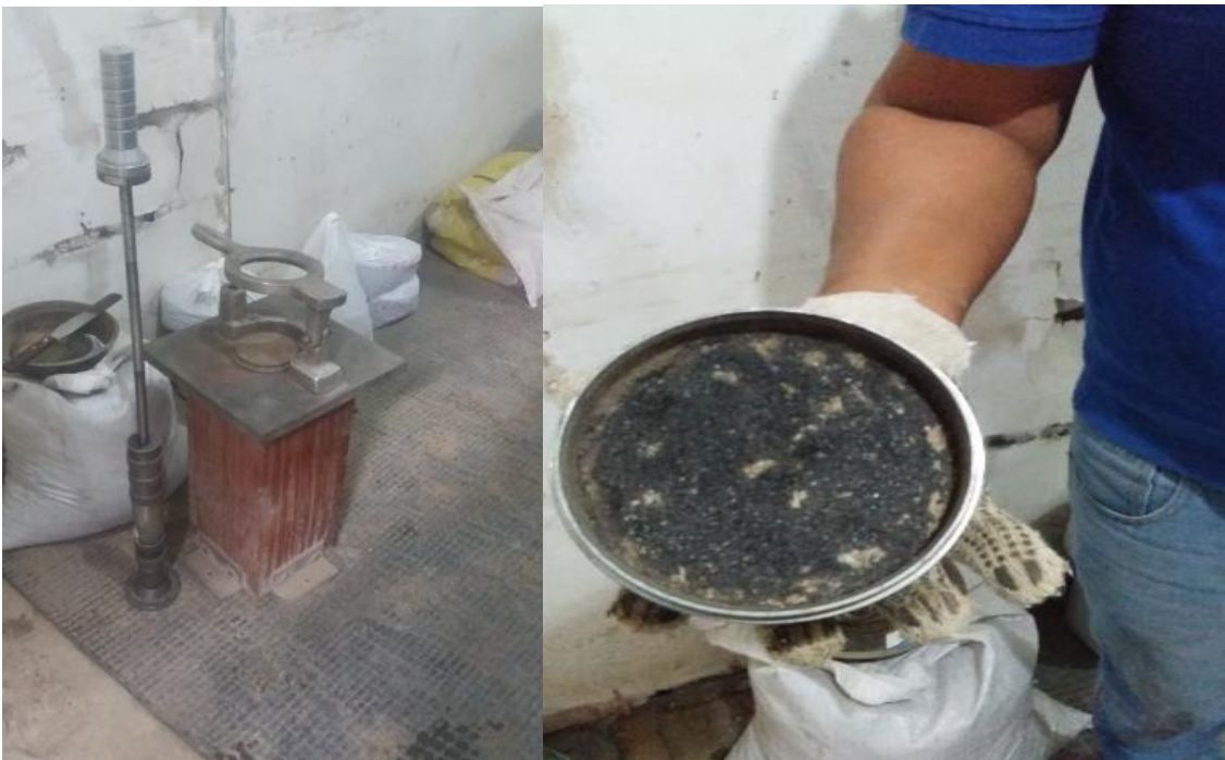
Figura 49. Elaboración de las briquetas con 75 golpes en cada cara Fuente: elaboración propia.
