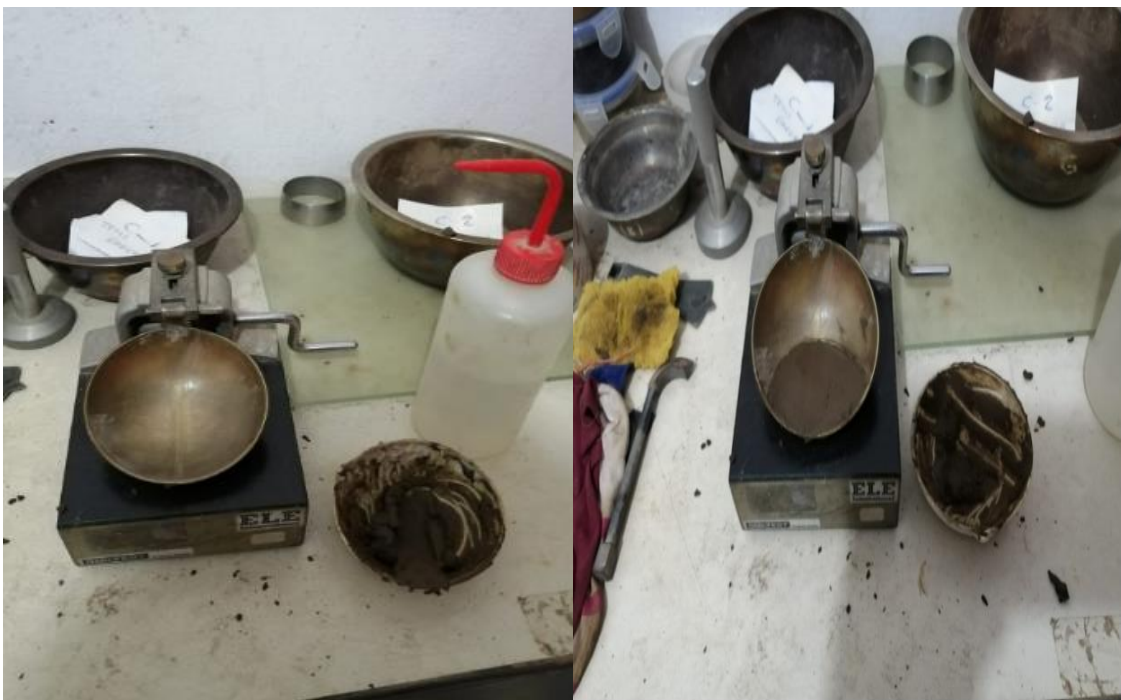
Figura 35. Equipos para el Ensayo de Índice de plasticidad de la malla N°200
