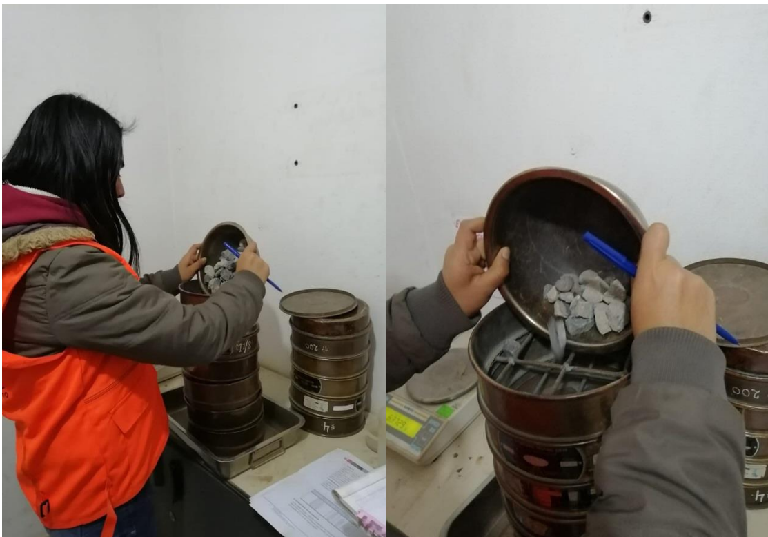
Figura 33. Vaciado de la grava seca en los tamices Fuente: elaboración propia.
