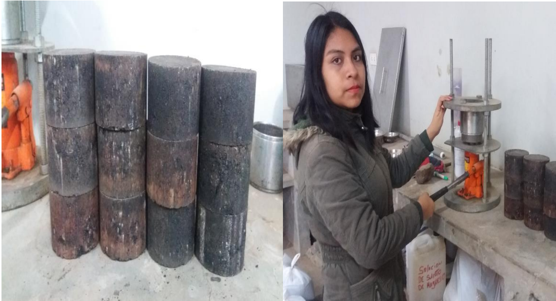
Figura 50. Desmontaje de briquetas con diversas dosificaciones de cemento asfáltico
