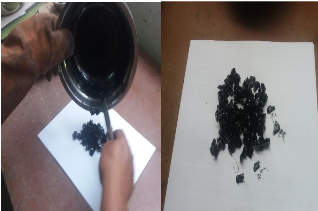
Figura 55. Muestra del ensayo de Stripping-Adherencia de agregado grueso
