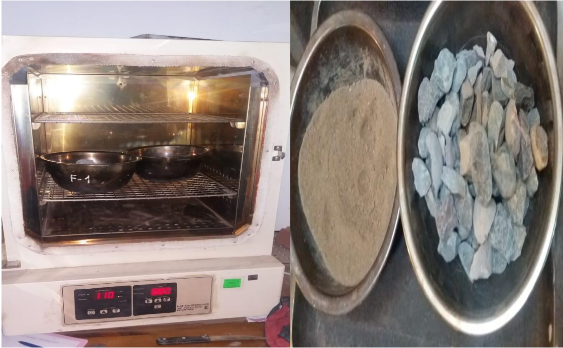
Figura 32. Secado de la grava y arena en el horno Fuente: elaboración propia.
