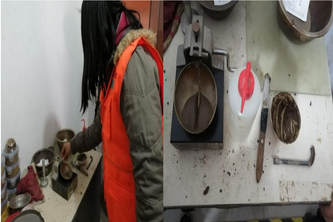
Figura 36. Realización del ensayo de límite líquido
