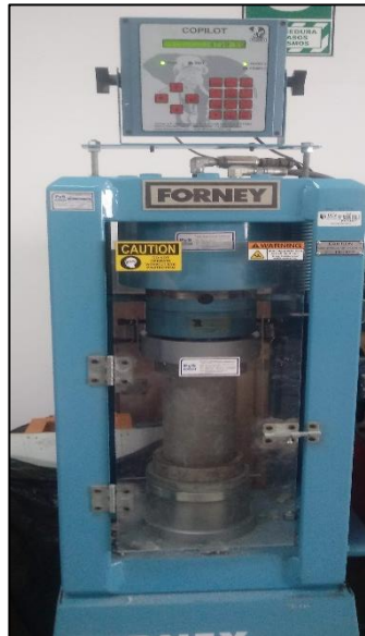
Figura 8. Prensa a compresión
