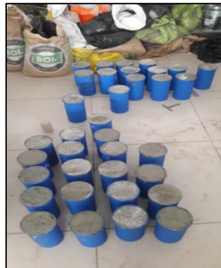
Figura 7. Probetas de concreto recién elaborada
