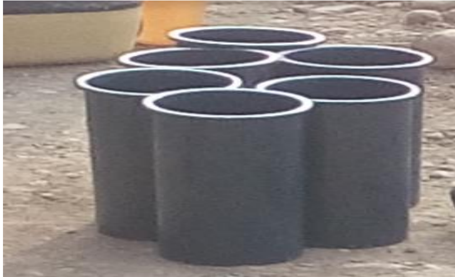
Figura 12. Moldes de PVC para probetas, por M. Centeno, 2019.
