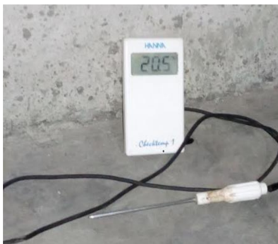
Figura 11. Termómetro para temperatura del concreto y ambiental, por M. Centeno, 2019.
