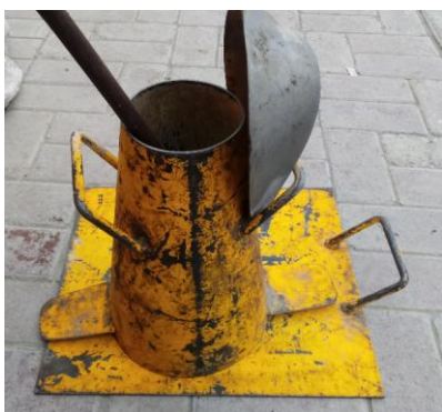
Figura 10. Cono de Abrams, por M. Centeno, 2019.
