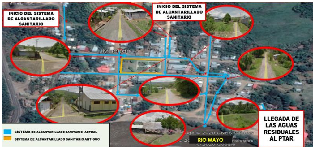
Imagen 04: Alcantarillado sanitario antiguo y actual
