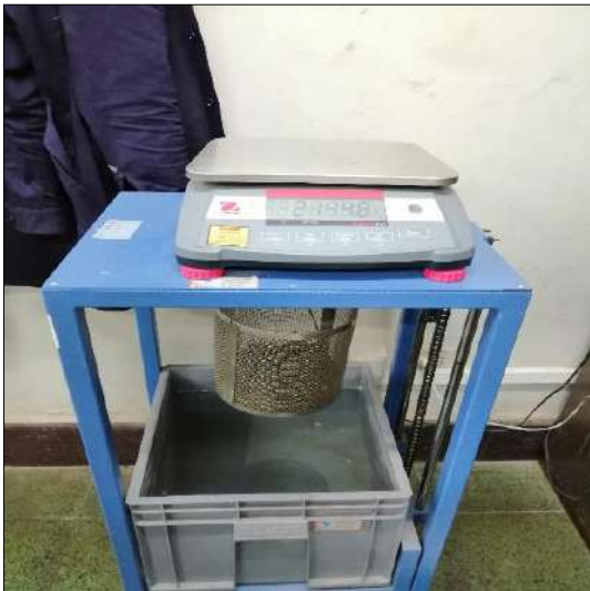
Peso específico y absorción de grava
