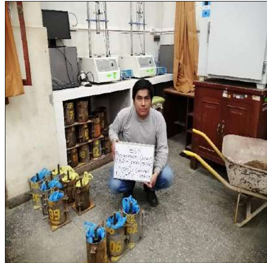
Curado de especímenes compactados por un período de 4 días
