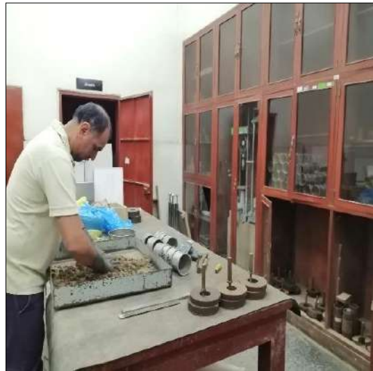
Preparación de solución y adición de TerraSil 1.50 Lt/m 3
