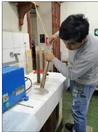
Figura 9. Ensayo de equivalente de arena
