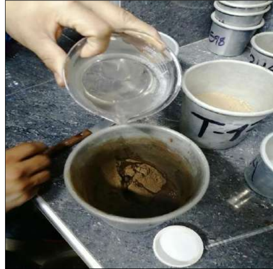
Adición de solución de TerraSil en muestras < N°40 Cantera la Campana
