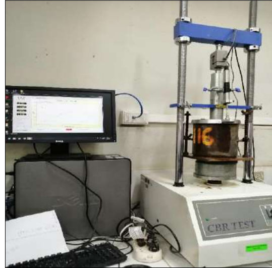
Control de absorción y penetración de especímenes compactados
