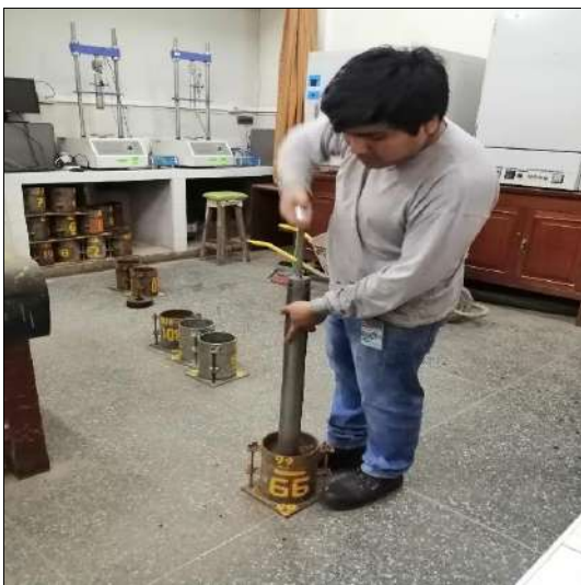
Compactación de especímenes con solución de Terrasil 1.25 Lt/m 3
