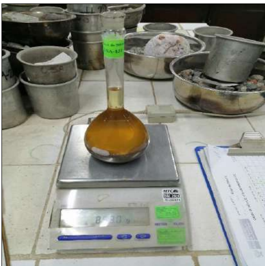
Gravedad específica y absorción de finos
