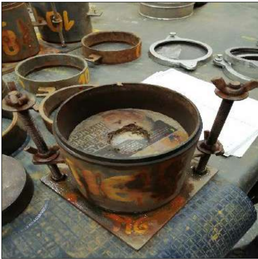
Condición de espécimen luego de penetración Preparación de TerraSil 1.00 Lt/m 3
