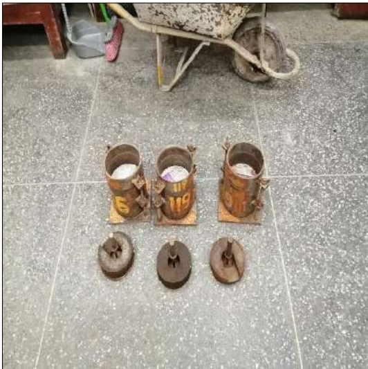
Procedimiento C.B.R: Inmersión de especímenes compactados en agua
