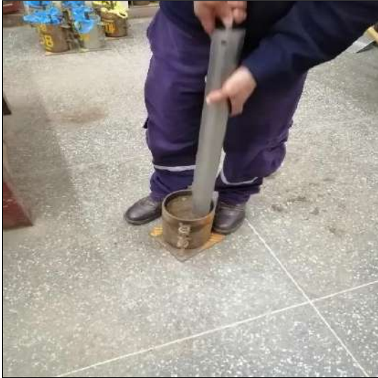
Compactación de especímenes con solución de Terrasil 1.00 Lt/m 3
