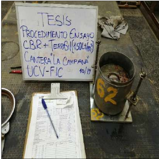
Condición de espécimen dosificado con TerraSil luego de penetración
