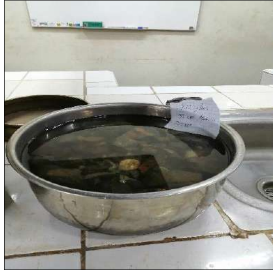
Peso específico y absorción de grava
