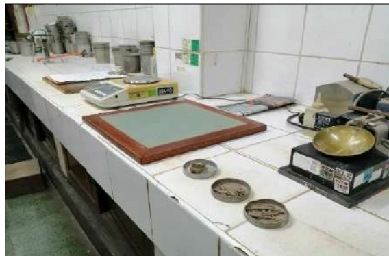
Figura 8. Ensayo de límite plástico de suelos
