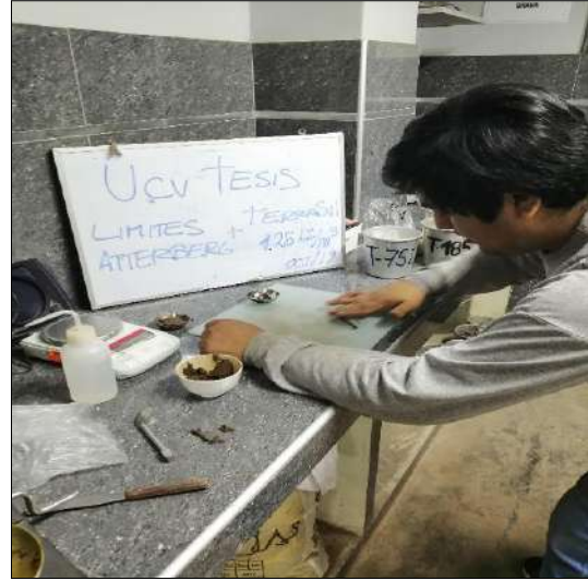
Procedimiento de ensayo de muestras dosificadas con TerraSil 1.25 Lt/m 3
