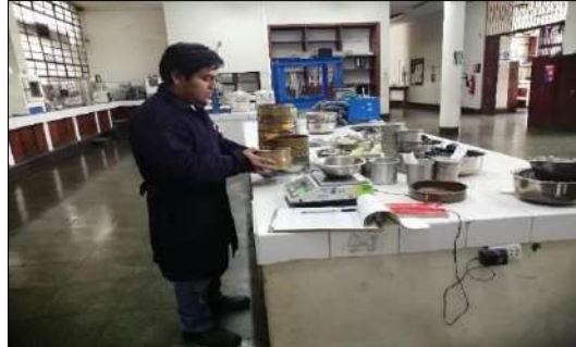
Figura 6. Ensayo de granulometría de suelos por tamizado
