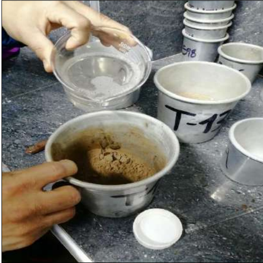
Adición de solución de TerraSil en muestras < N°40 Cantera la Campana
