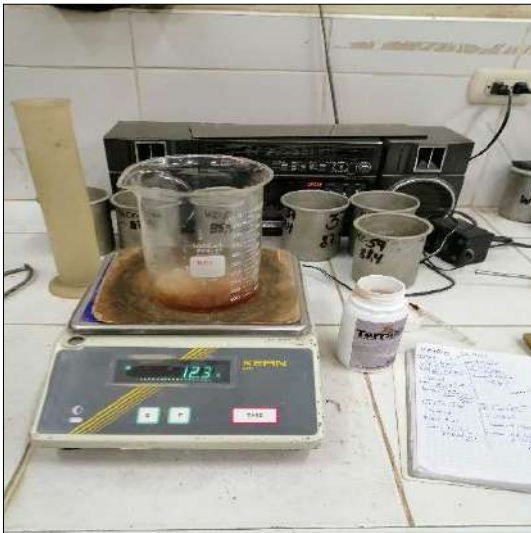
Preparación de solución y adición de TerraSil 1.25 Lt/m 3
