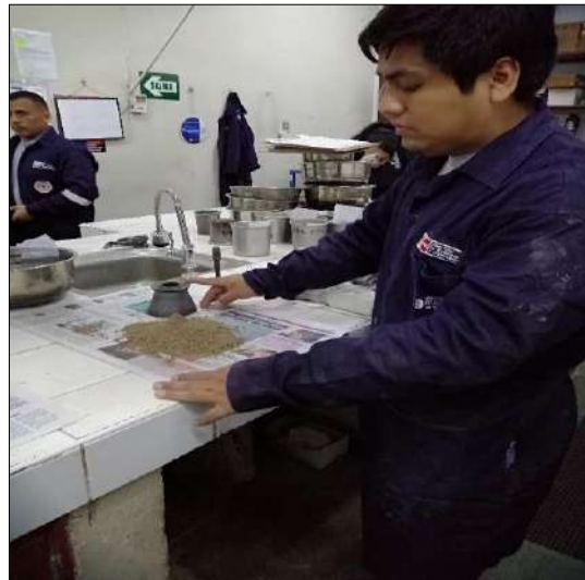
Gravedad específica y absorción de finos
