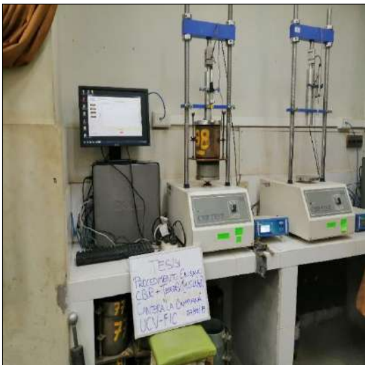
Control de absorción y penetración de especímenes dosificados con TerraSil
