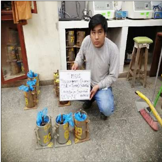
Curado de especímenes compactados por un período de 4 días
