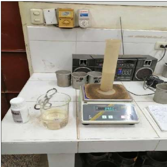
Preparación de solución y adición de TerraSil 1.50 Lt/m 3
