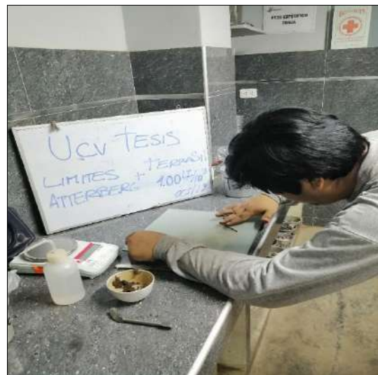
Procedimiento de ensayo de muestras dosificadas con TerraSil 1.00 Lt/m 3
