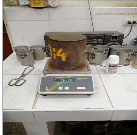
Compactación de especímenes con solución de Terrasil 1.00 Lt/m 3
