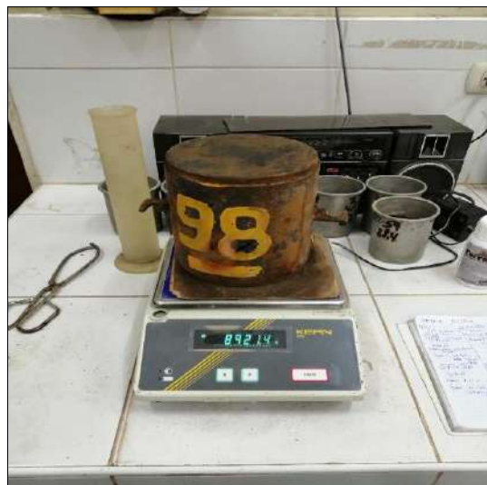
Compactación de especímenes con solución de TerraSil 1.50 Lt/m 3
