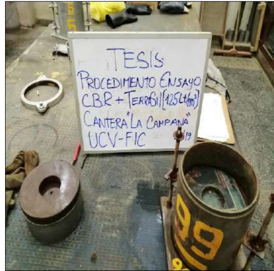
Condición de espécimen dosificado con TerraSil luego de penetración
