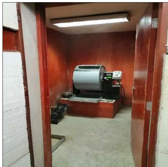
Abrasión en máquina de los ángeles
