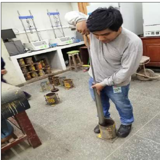
Compactación de especímenes con solución de TerraSil 1.50 Lt/m 3
