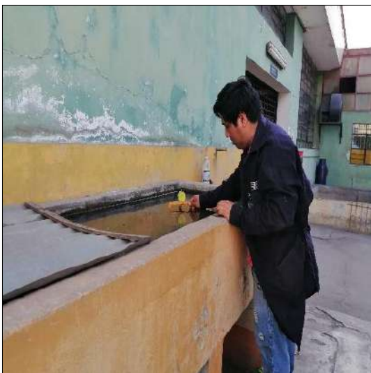
Medición de expansión y escurrimiento de especímenes compactados
