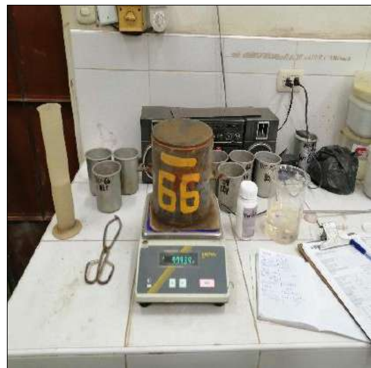
Compactación de especímenes con solución de Terrasil 1.25 Lt/m 3
