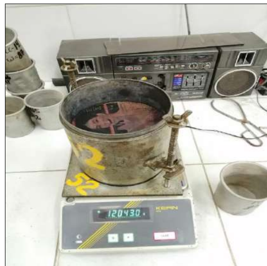
Medición de expansión y control de absorción de especímenes dosificados con TerraSil
