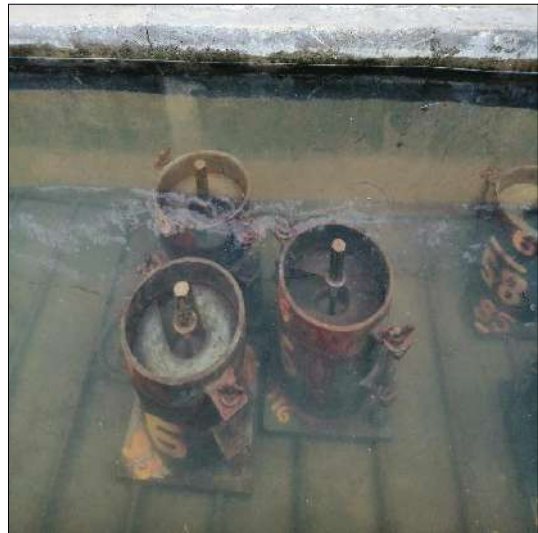
Procedimiento C.B.R: Inmersión de especímenes compactados en agua
