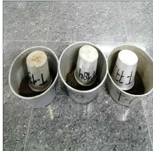
Adición de solución de TerraSil en muestras < N°4 Cantera la Campana
