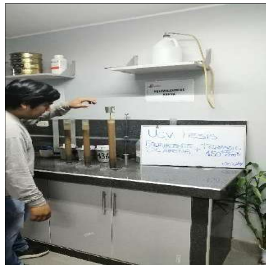
Procedimiento de ensayo de muestras dosificadas con TerraSil 1.50 Lt/m 3
