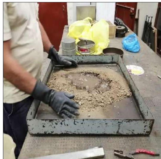
Preparación de solución y adición de TerraSil 1.00 Lt/m 3
