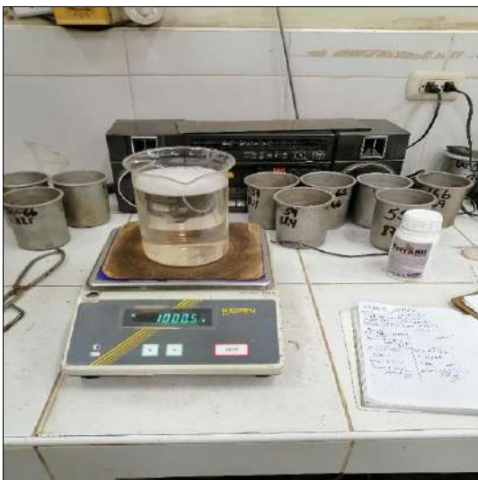
Preparación de solución y adición de TerraSil 1.00 Lt/m 3
