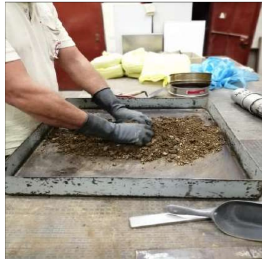
Preparación de solución y adición de TerraSil 1.25 Lt/m 3
