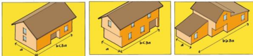
Figura 5: Irregularidad en planta. Fuente: Manual AIS
