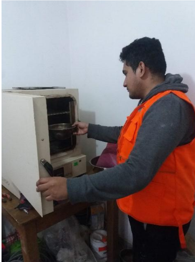
Figura 35: Contenido de humedad, secando la muestra en el horno
