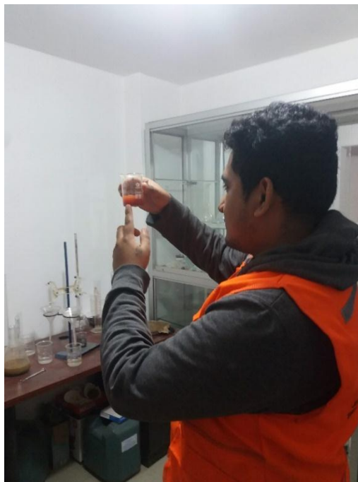
Figura 40: Ensayo para cloruros
