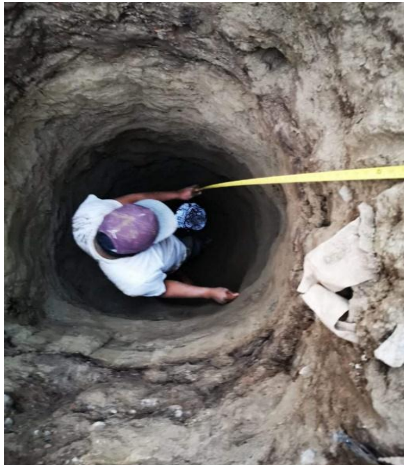
Figura 33: Ubicación del nivel freático a 3m calicata N° 3
