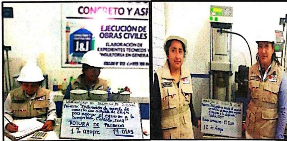
Rotura de probeta con incorporación de 1% de azufre a los 14 días de edad.
