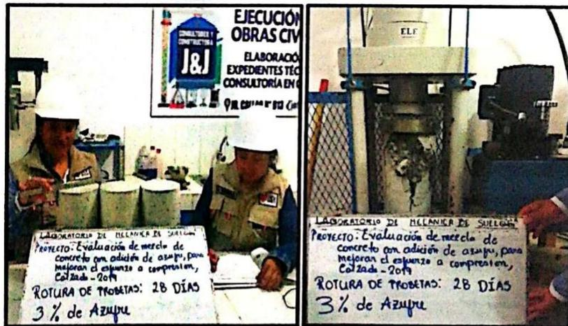
**Rotura de probeta con incorporación del 3% de azufre a los 28 días de edad.**
