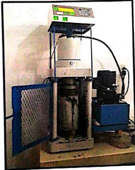
Rotura de probetas a los especímenes de los 7 días (concreto convencional).
