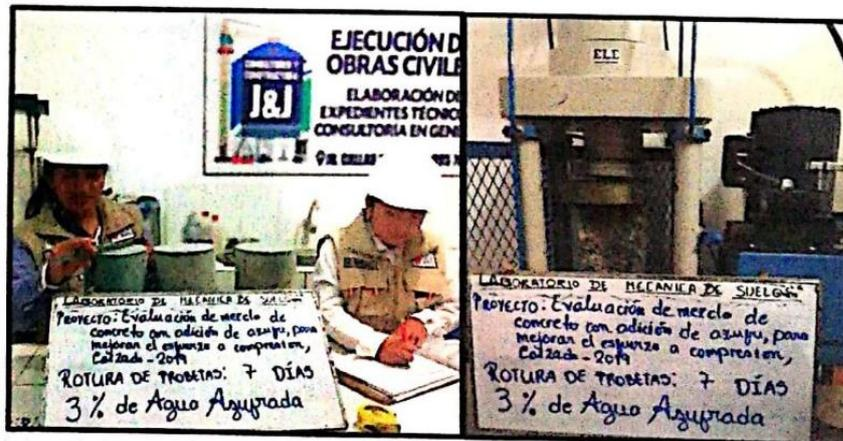
Rotura de probeta con incorporación del 3% de azufre a los 07 días de edad.
