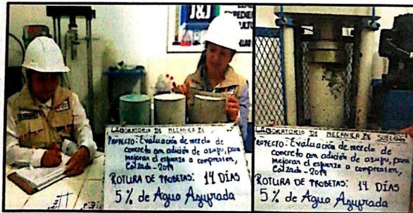
**Rotura de probeta con incorporación del 5% de azufre a los 14 días de edad.**
