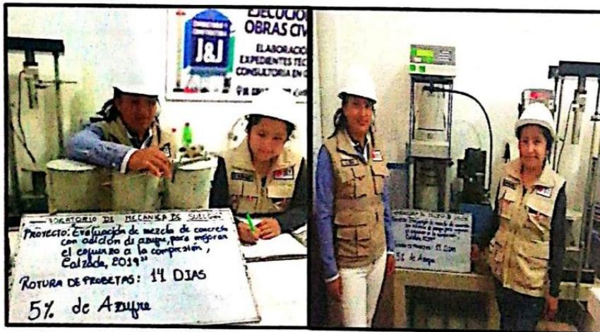
Rotura de probeta con incorporación del 5% de azufre a los 14 días de edad.
