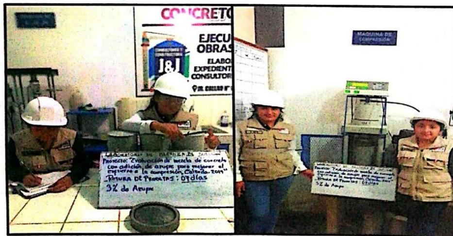
**Rotura de probeta con 3% de azufre a los 7 días de edad.**
