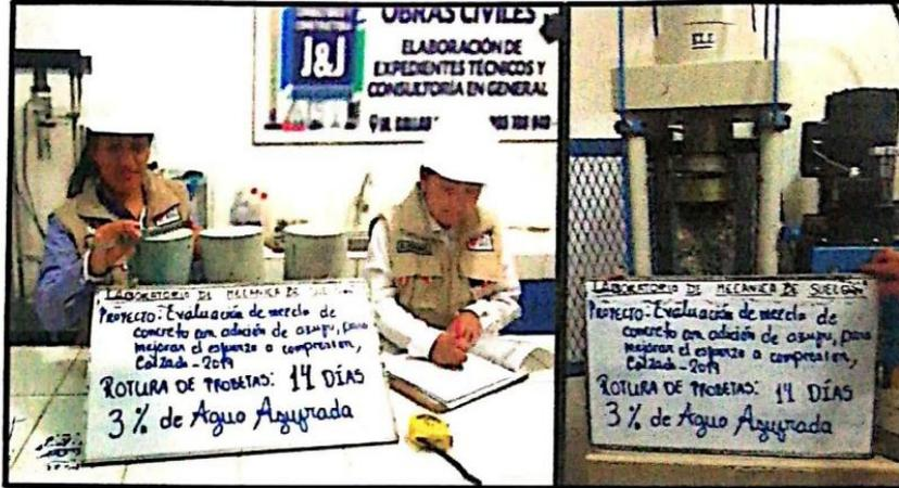
**Rotura de probeta con incorporación del 3% de azufre a los 14 días de edad.**
