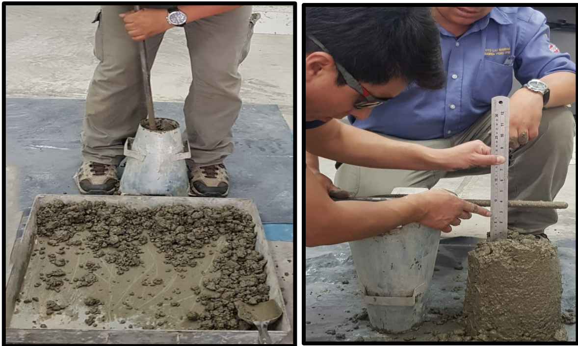
Ilustración 8: Elaboración de la mezcla y ensayo de Consistencia del Concreto.
