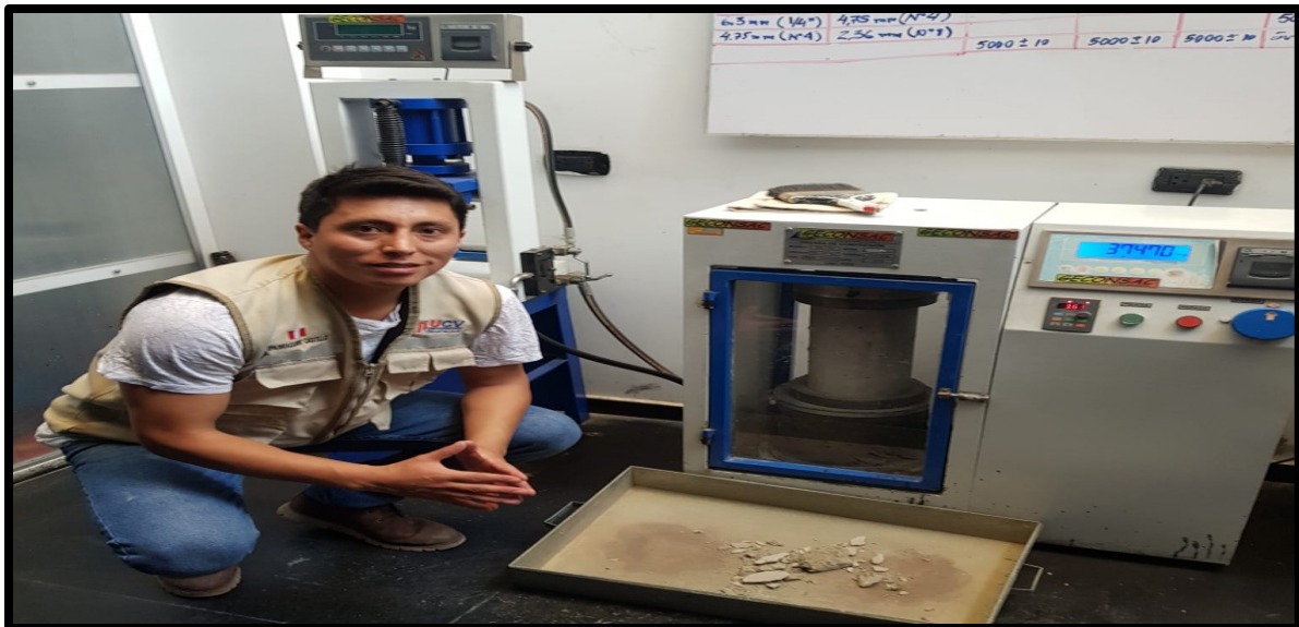
Ilustración 10: Rompimiento de probetas en la maquina correspondiente a los 07, 14 y 21 días.
