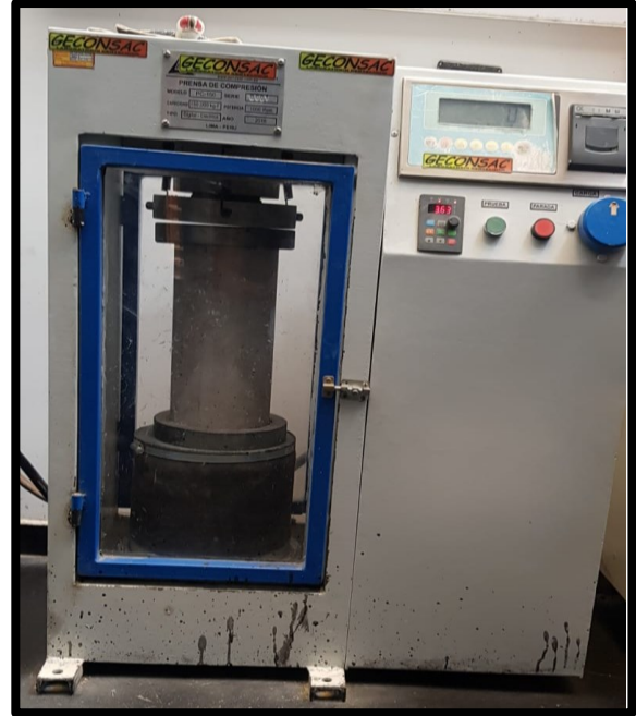
Ilustración 11: Rompimiento de probetas en la maquina correspondiente a los 071 14 y 21 días.
