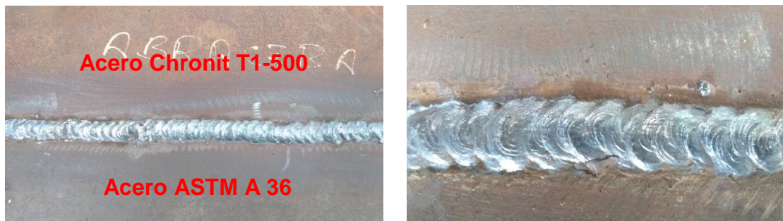
Figura 13. Probeta soldada con electrodo E 7018
