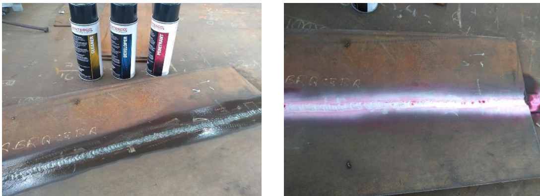
Figura14. Probeta ensayada con tinta penetrantes
