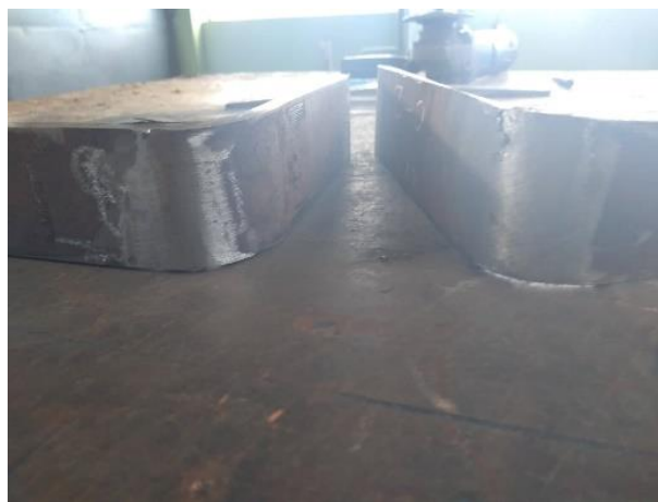
Figura 16. Probeta ensayada por doblado de raíz y de cara
