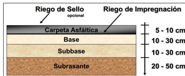
figura 06. Clasificación estructural del Pavimento Flexible
