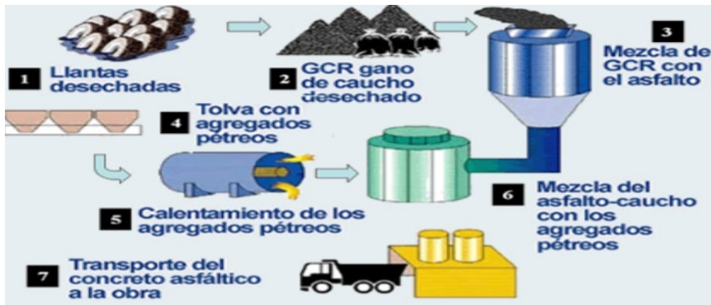
figura 05. Etapas en la fabricación del asfalto con caucho (vía húmeda)
