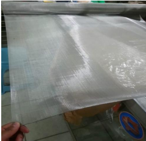
Tela de acero inoxidable con dimensión SWG36 X 40X1MX10M
