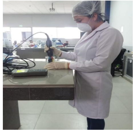
Análisis de pH, temperatura, sólidos totales, conductividad eléctrica con el multiparámetro
