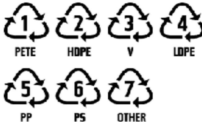
Figura 01. Sistema de identificación de resinas
