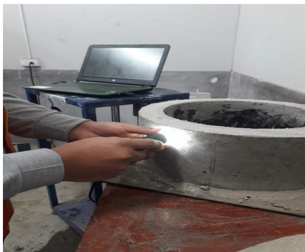
Figura 23. Medición de fisuras de los anillos
