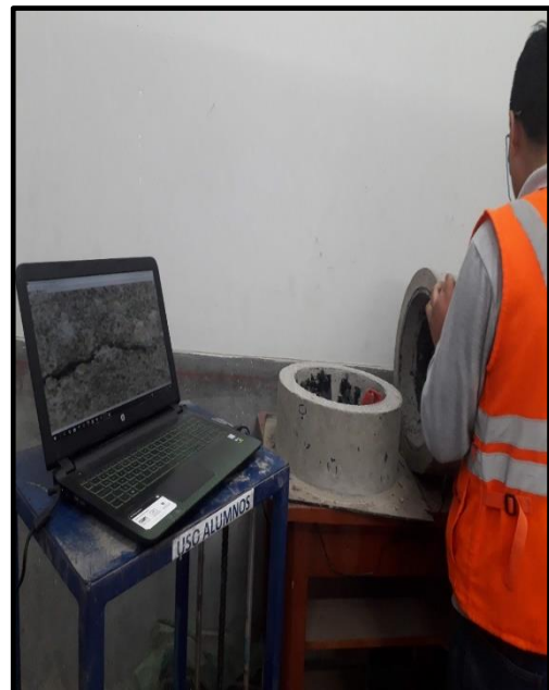
Conteo de fisuras en los anillos de concreto
