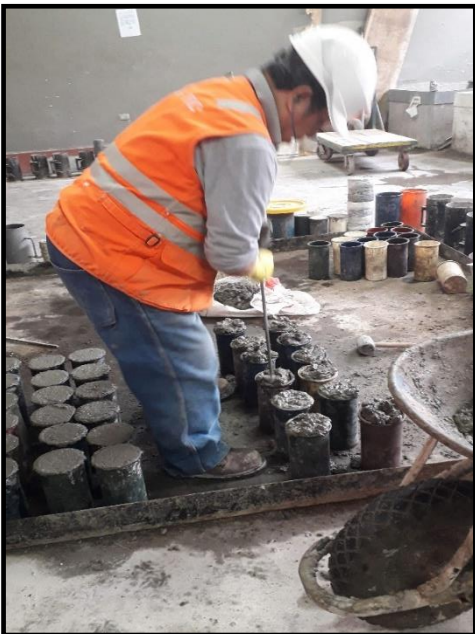
Dando los últimos 25 golpes a las probetas
