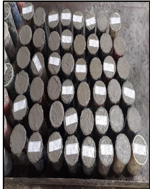
Elaboración de las 48 probetas propuestas
