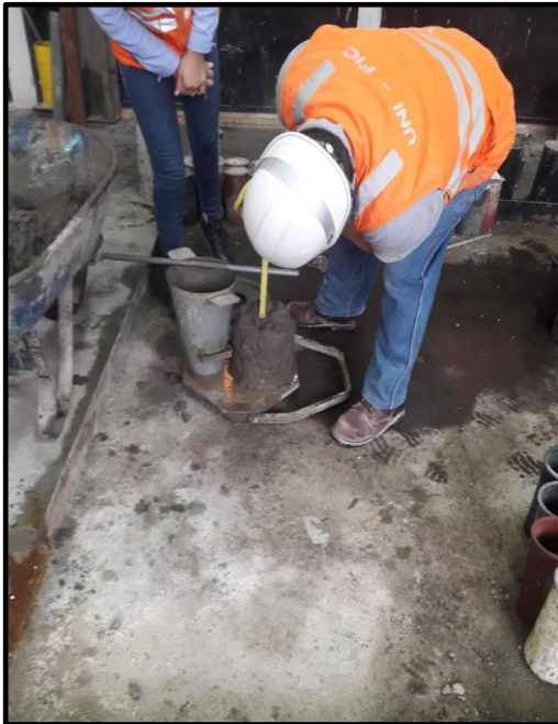
Medición del asentamiento del concreto
