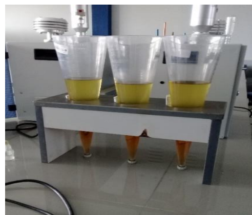
Decantación de biodiesel
