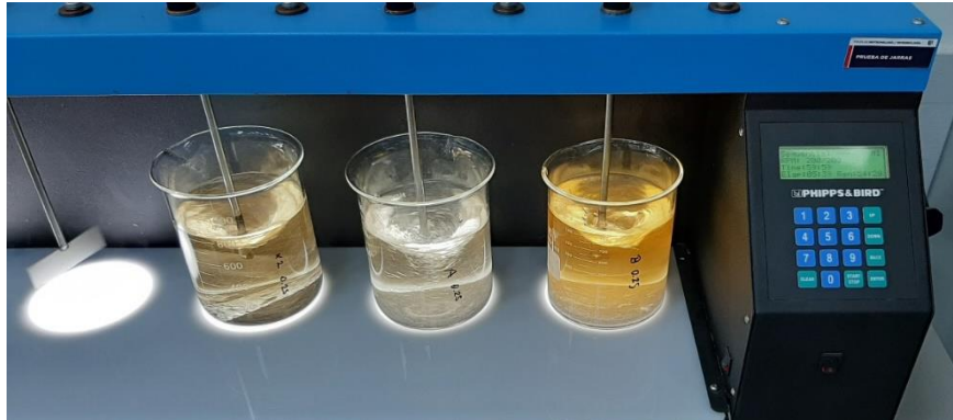
Prueba de jarras con el tratamiento del alga ( Chondracanthus chamissoi ) y cáscara de banano ( Musa paradisiaca .)
