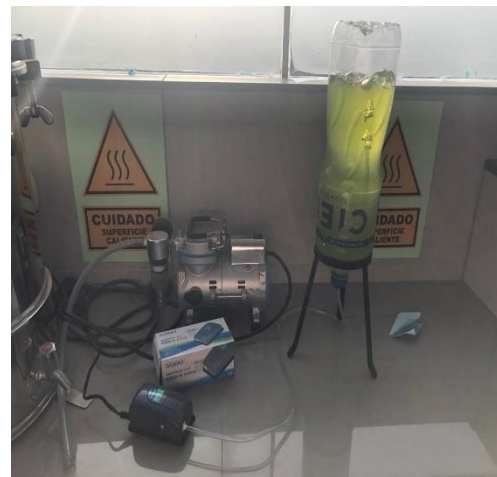
Microalga Scenedesmus sp en fotobiorreactor manual con capacidad de 2.5 ltrs.c
