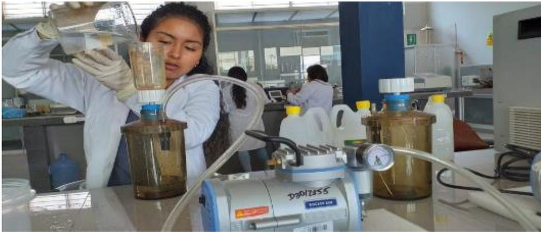
Filtrado de las muestras después de las pruebas de adsorción con quitosano
