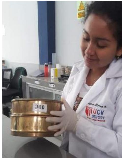
Tamizado del quitosano utilizando una malla de 250  $\mu$ m.
