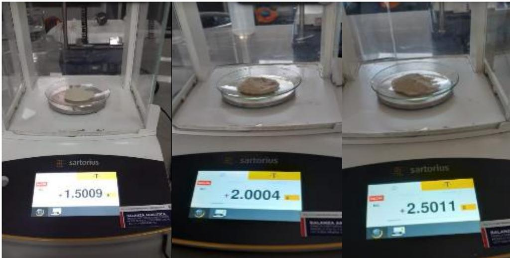
Dosificación de quitosano para cada prueba de adsorción de plomo.
