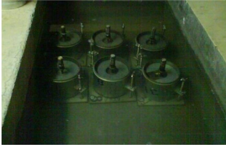
**Figura 11:** Sumergimiento de moldes de CBR.
