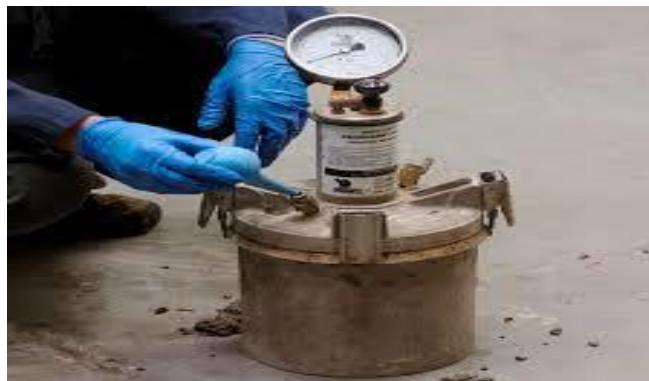
Figura 9. Olla de Washington cámara de aire vertical adaptada ASTM C231.
