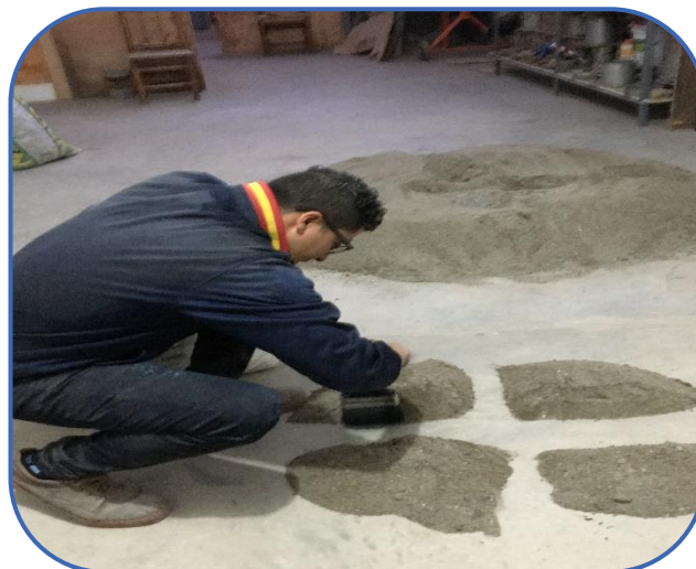
Figura 8: Cuarteo de material
