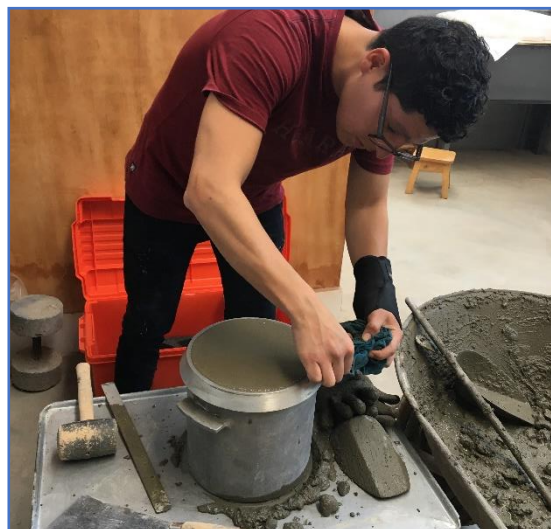
Figura 29: Limpieza de los bordes de la olla de washinton
