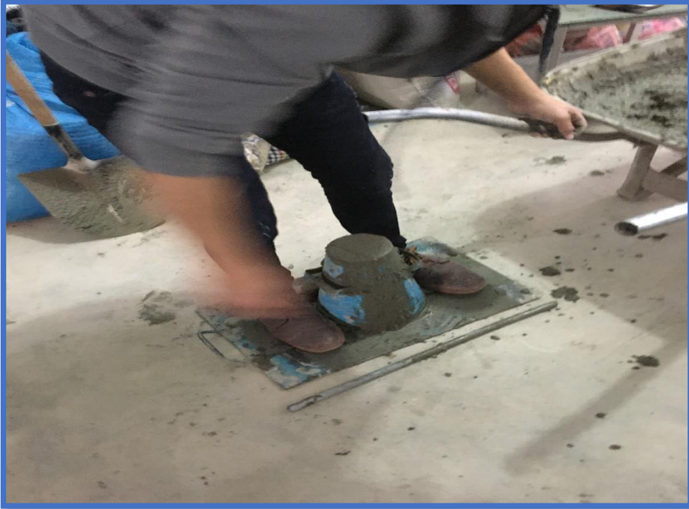
Figura 26: Proceso del colocado del concreto en el cono
