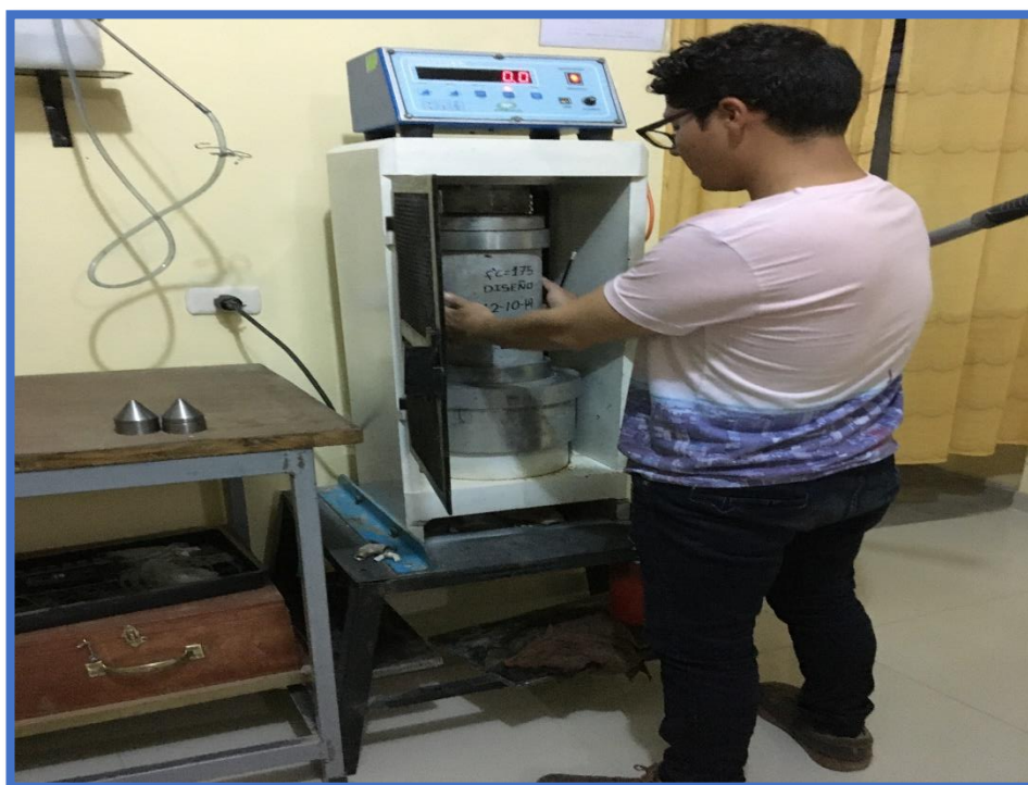
Figura 35: Roturas de probetas
