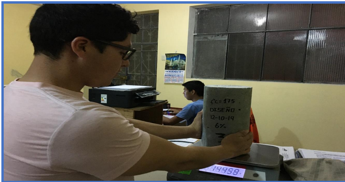
Figura 34: calculando el peso del testigo de concreto
