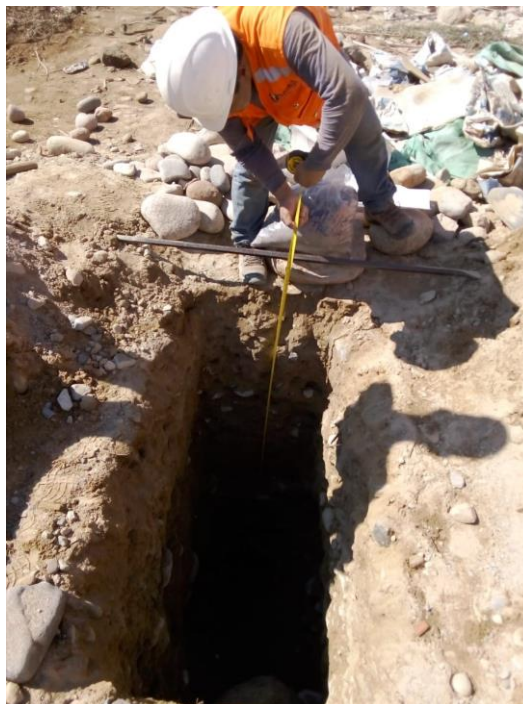
Figura 10. Procedimiento de Calicata para sacar la muestra
