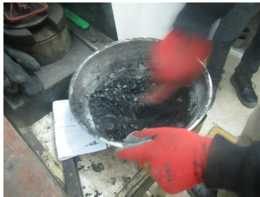
Figura 37: Mezcla del PEN 60/70 y Agregados
