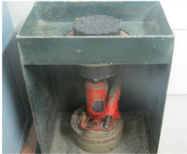
Figura 40: Desmoldación en Prensa
