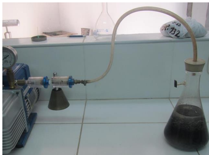
Figura 45: Ensayo Máxima Gravedad Específica
