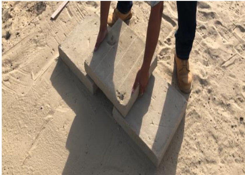
Fotografía 27: Preparación para prueba de resistencia en campo
