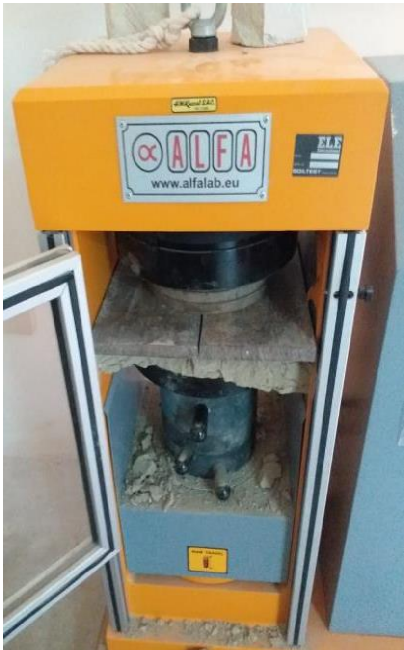
Fotografía 50: Fractura del bloque de adobe con incorporación de garbancillo al 20 %
