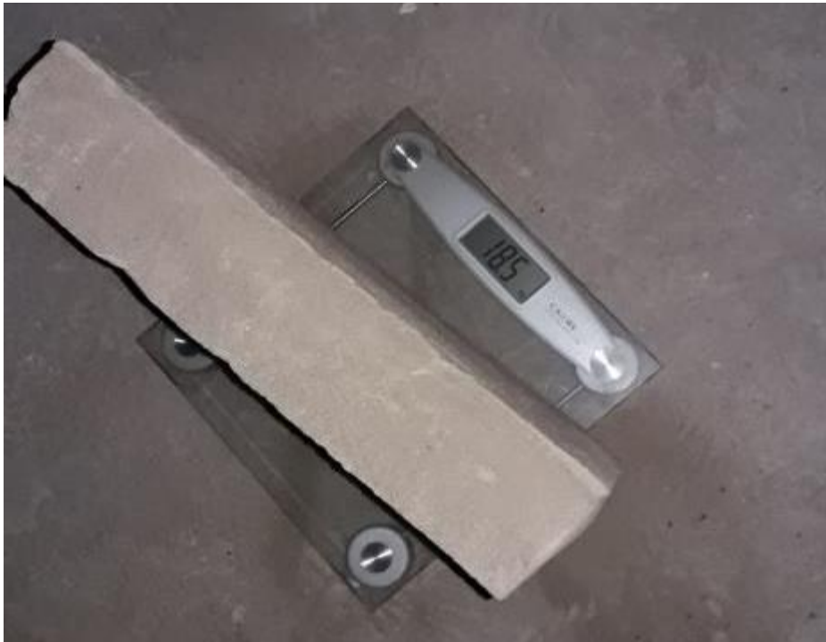
Fotografía 38: Pesaje de adobe con incorporación del 10% de garbancillo
