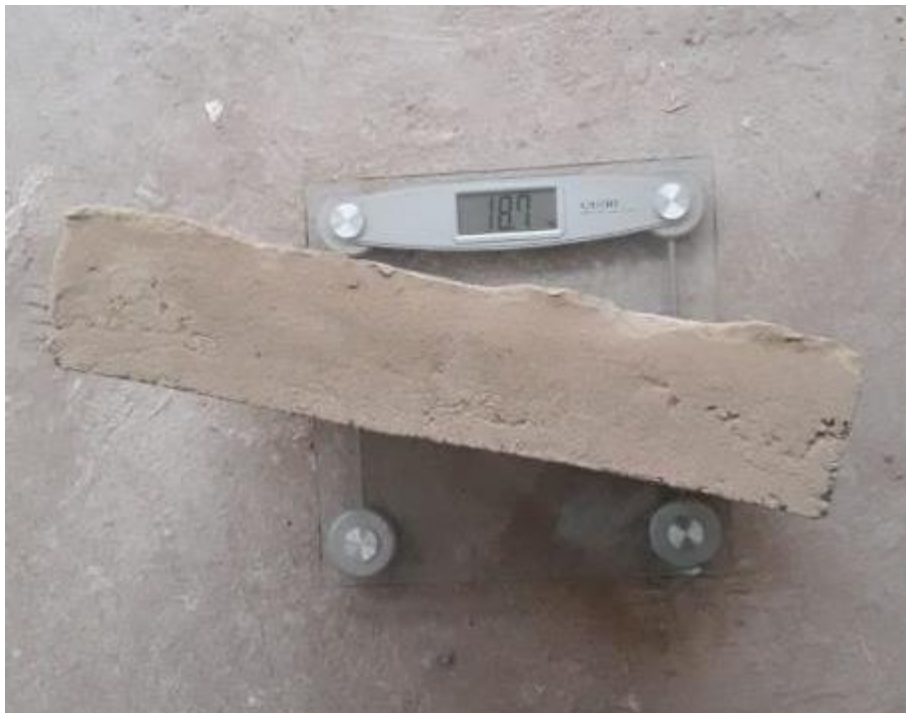
Fotografía 38: Pesaje de adobe con incorporación del 10% de garbancillo
