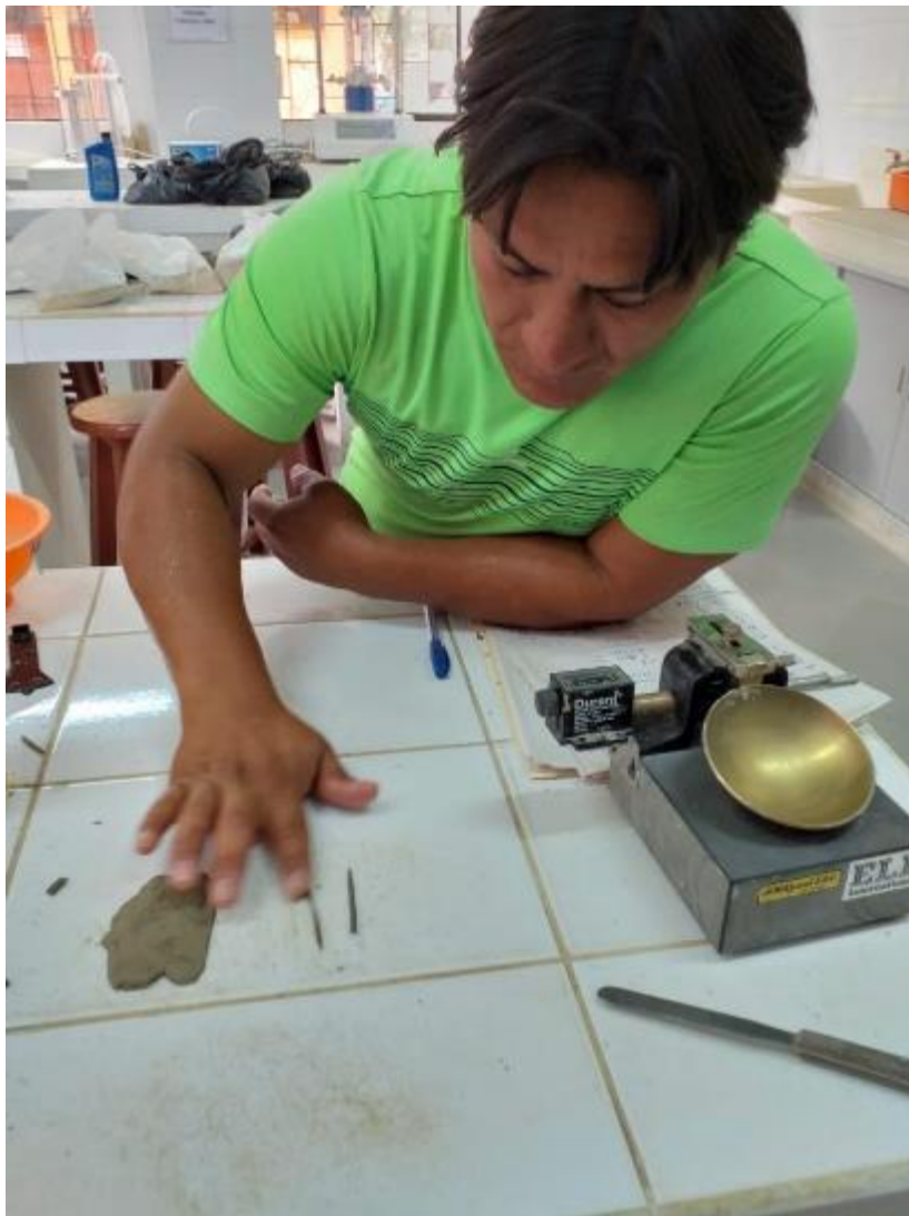
Fotografía 42: Comportamiento de arcilla durante su secado
