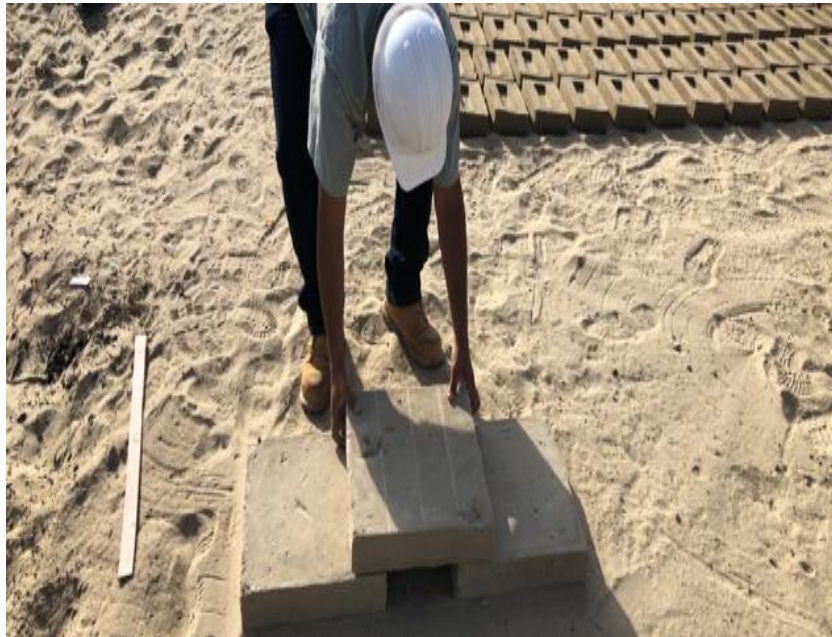
Fotografía 28: Preparación para prueba de resistencia en campo
