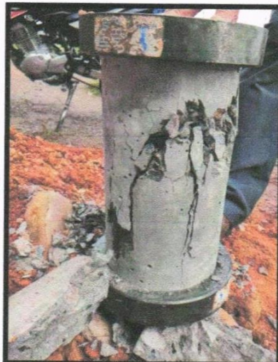
Paso 6: Rotura de probetas f_c = 210 \text{ kg/cm}^2 (convencional).
