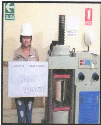
Paso 6: Rotura de probetas f_c = 210 \text{ kg/cm}^2 (convencional).
