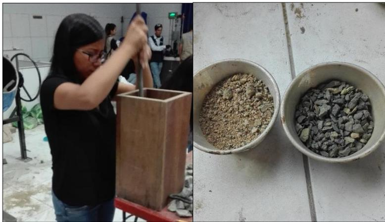
Ensayos de agregados. Peso unitario compactado y contenido de humedad.
