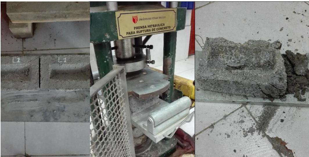
Rotura de ladrillos después del curado.
