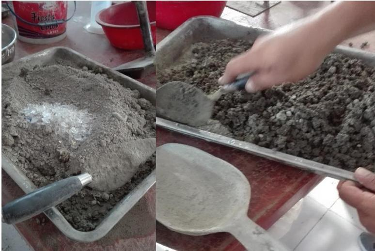
Preparación de ladrillos con adición de vidrio reciclado triturado.
