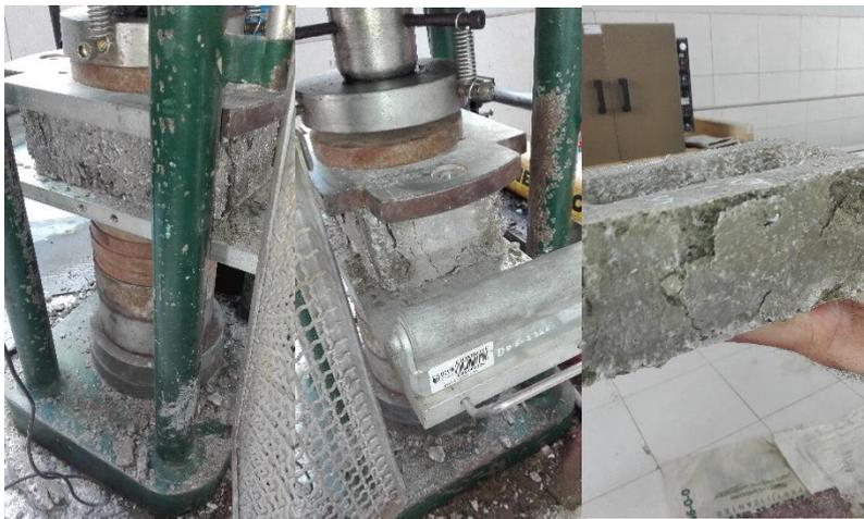
Ensayo de resistencia a la compresión.
