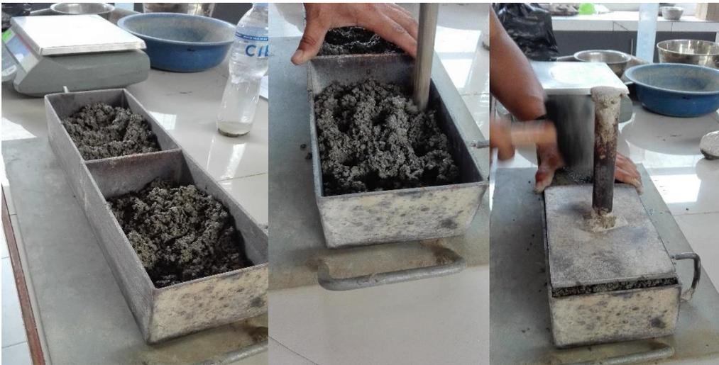
Llenado de molde metálico con la mezcla de concreto.
