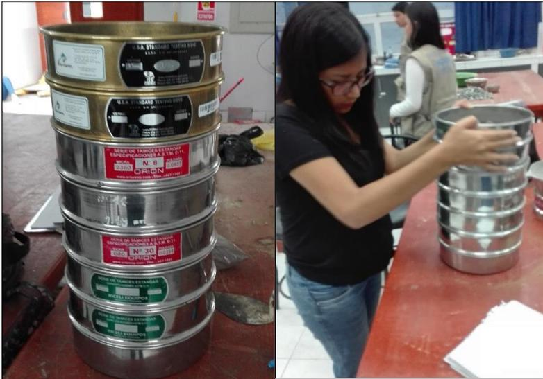
Tamices utilizados en el ensayo de granulometría.
