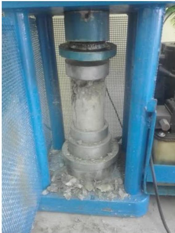
Identificación del tipo de rotura de testigos acorde a NTP.
