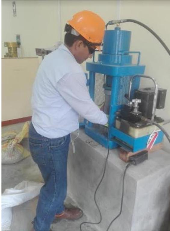
Rotura de testigos de concreto para obtención de resistencia a la compresión  $f'_c$
