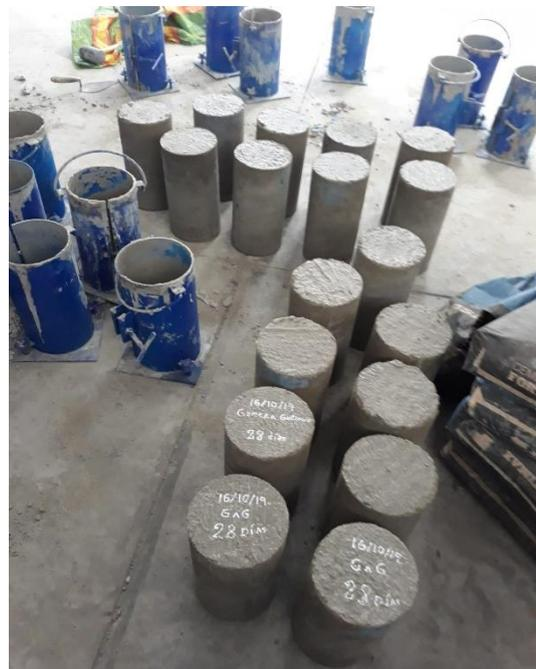
Figura 19. Desencofrado de las probetas
