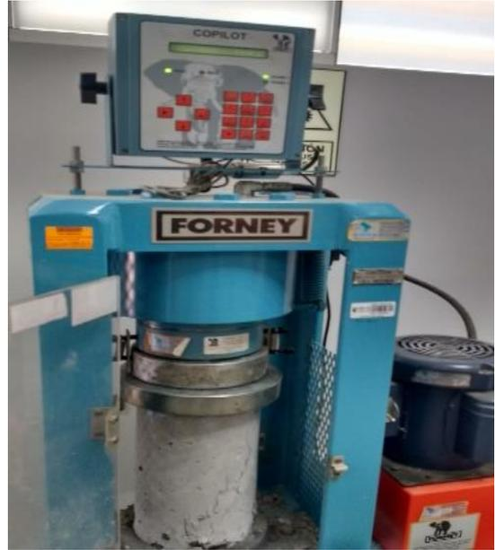
Figura 25. Rotura de Probeta
