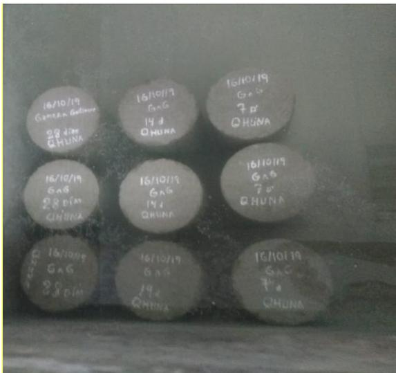
Figura 21. Curado de probetas
