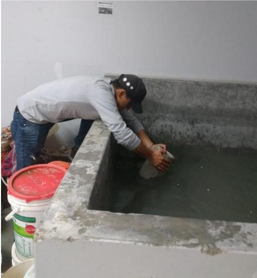
Figura 20. Colocación de probetas en la piscina
