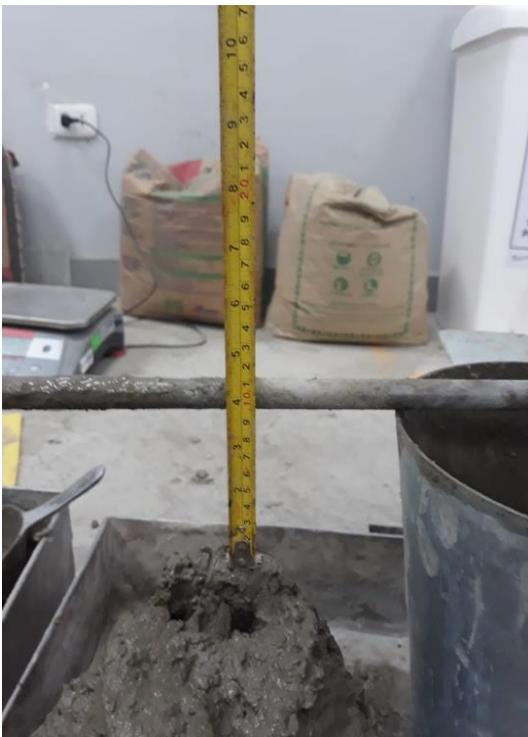
Figura 17. Determinación de Slump
