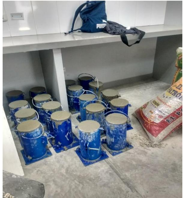
Figura 18. Mezcla compactada en los especímenes
