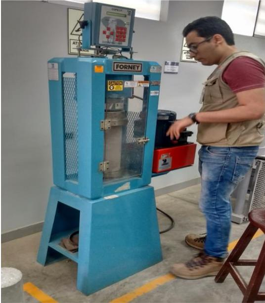
Figura 24. Máquina de rotura a la compresión
