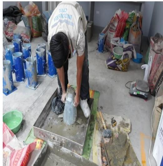
Figura 15. Ensayo de Cono de Abraham
