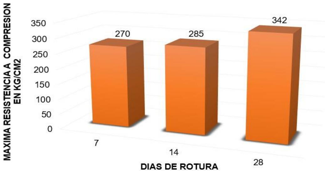
Figura 35. Resumen de roturas de probetas con aditivo Sikament 306 y Plastiment TM-12
