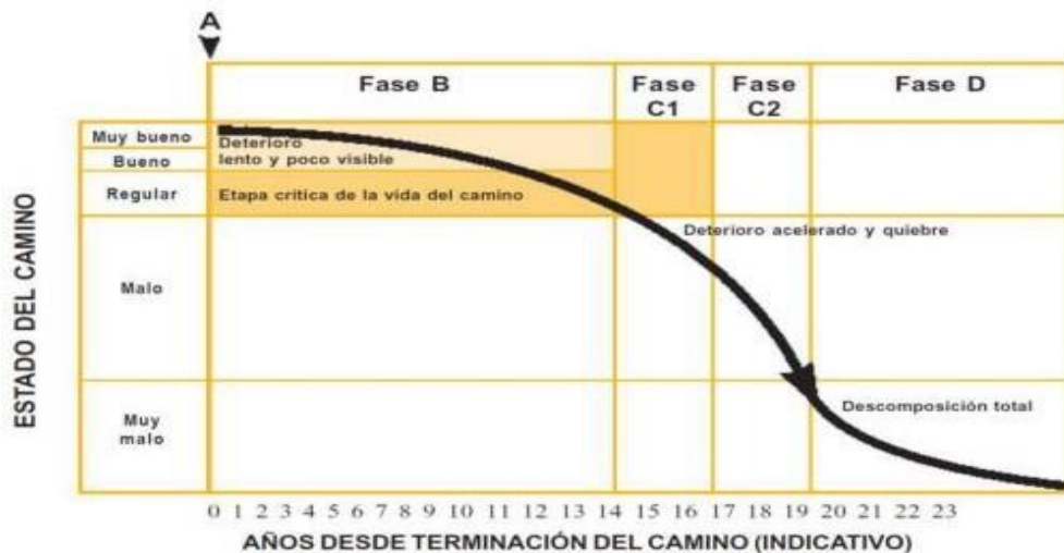
Figura 2. Etapas de deterioro en el pavimento flexible.
