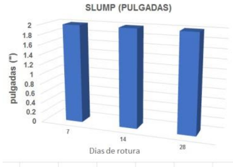
Figura 40. Asentamiento del concreto sin aditivo
