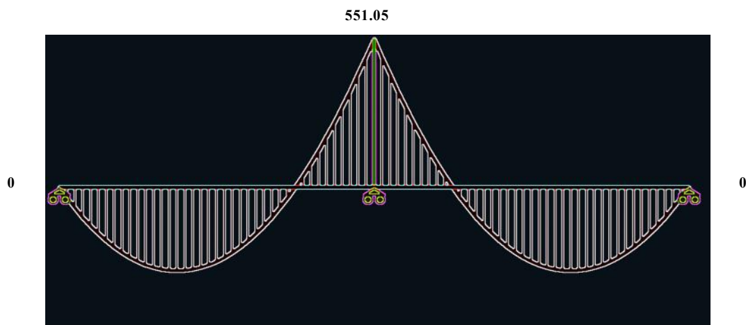
Figura 31: Diagrama de Momento flector.
