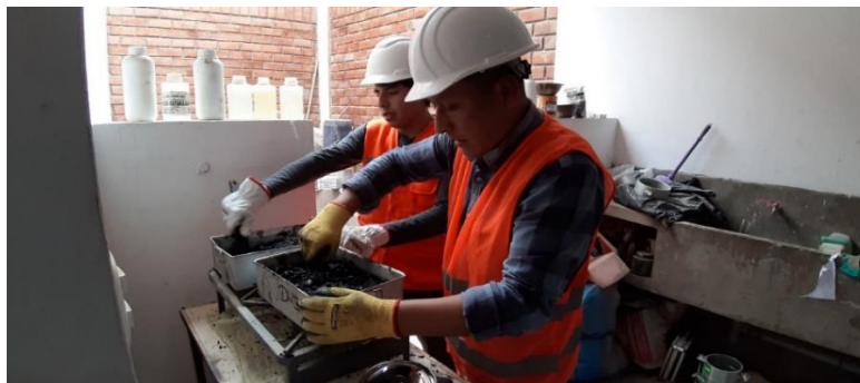
Figura N° 74: Proceso de mezclado del asfalto.
