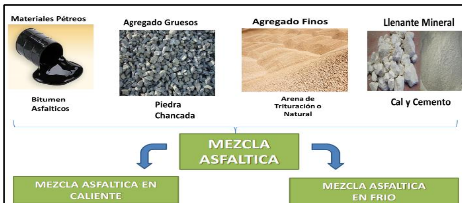
Figura N° 28: Materiales de uso en pavimentos flexibles
