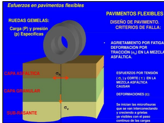
Figura N° 17: Esfuerzo en pavimentos flexibles
