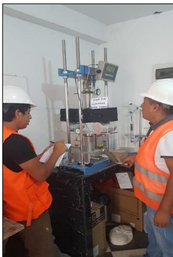
Figura N° 90: Gráfico de proceso del ensayo de flexión
