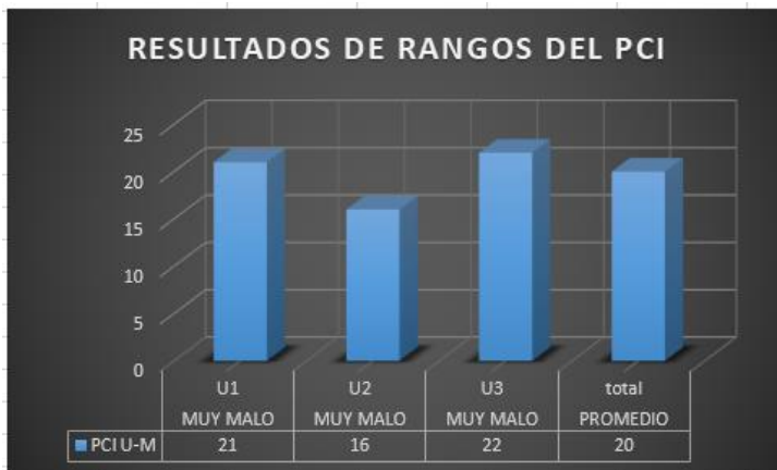
Figura N° 39: Porcentaje de fallas cada unidad del estudio mediante el método PCI.
