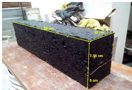
Figura N° 80: Gráfico de medidas de la viga con geomalla fibra de vidrio
