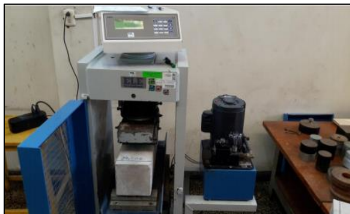
Figura N° 21: Máquina para método de flexión
