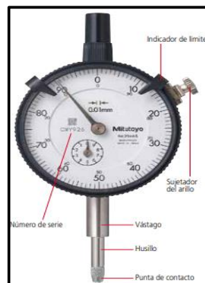
Figura N° 98: Gráfico del dial indicador de medición
