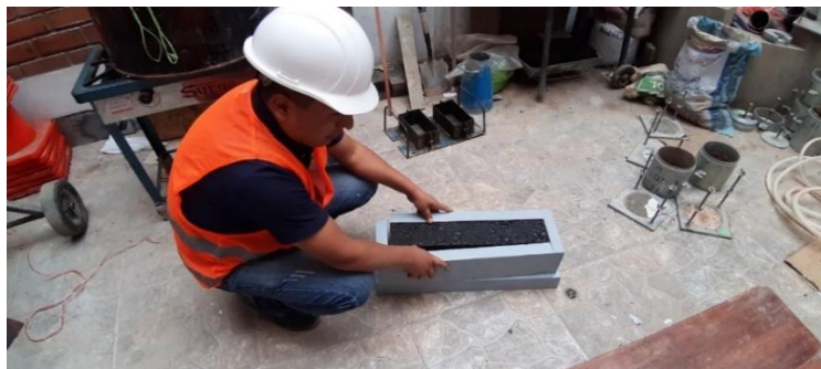
Figura N° 77: Desencofrado del ensayo de las vigas.
