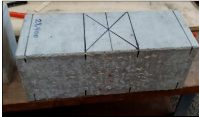
Figura N° 22: Probetas prismáticas: vigas
