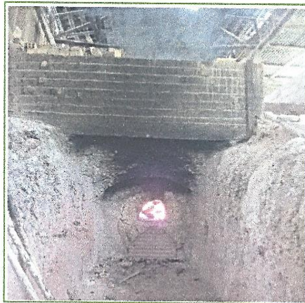
➤ DESIDRATACION DE LA PIEDRA CALIZA A UNA TEMPERATURA DE 1800°C PARA LA ELAVORACION DE LA CAL APAGADA Y CAL VIVA.
