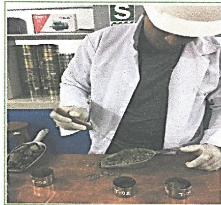
➤ DETERMINACIÓN DEL CONTENIDO DE HÚMEDA DEL AGREGADO FINO
