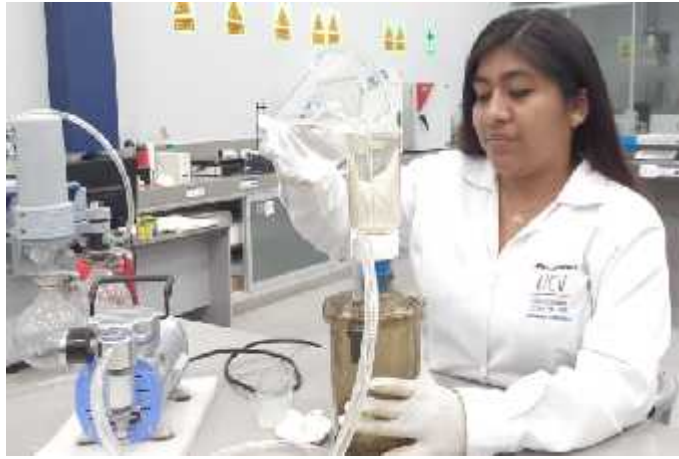
Filtración de la muestra tratada utilizando la bomba al vacío y papel filtro de 47 \mu\text{m}
