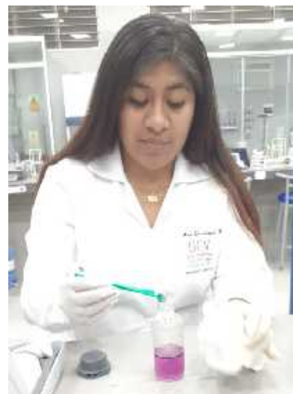
Cucharilla verde, dosificadora de \text{As}_3 el cual contiene zinc liberando gas arsina
