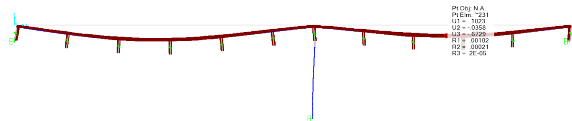
Figura 140: Deflexión máxima en el centro de la luz del primer tramo para caso de carga HL-93 S/Sobrecarga.
