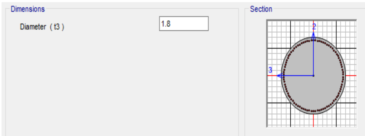
Figura 162: Sección de pilar en CSiBRIDGE
