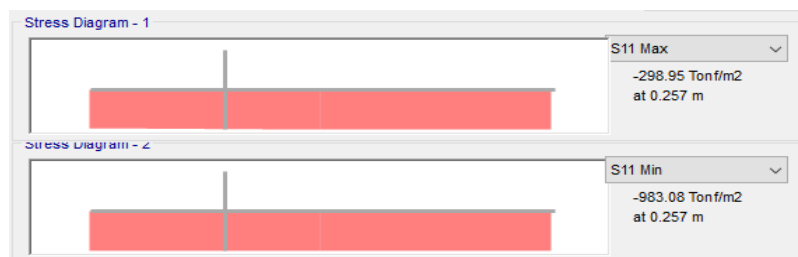
Figura 77: Esfuerzos a tracción y compresión del concreto después de tensado a la edad de 7 días (etapa de transferencia) – TRAMO 1
