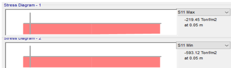
Figura 78: Esfuerzos a tracción y compresión del concreto después de tensado a la edad de 7 días (etapa de transferencia) – TRAMO 1
