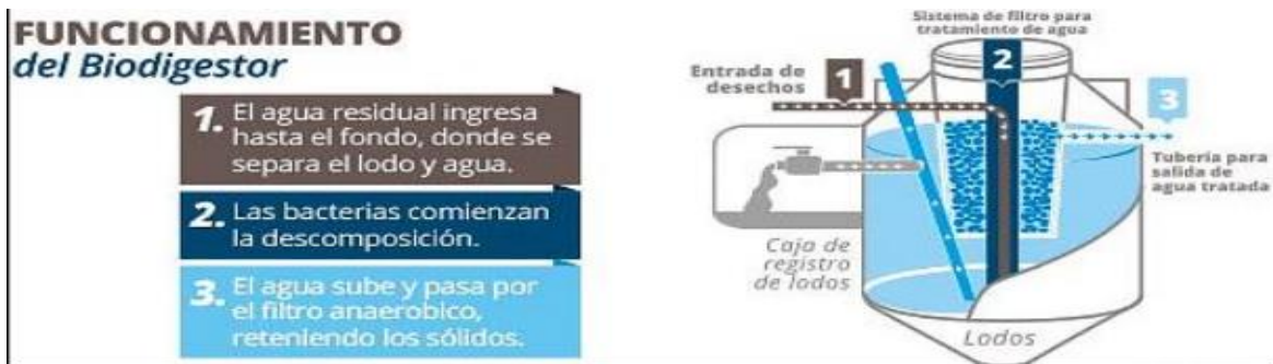
Figura 02. Funcionamiento del biodigestor en una vista interna.
