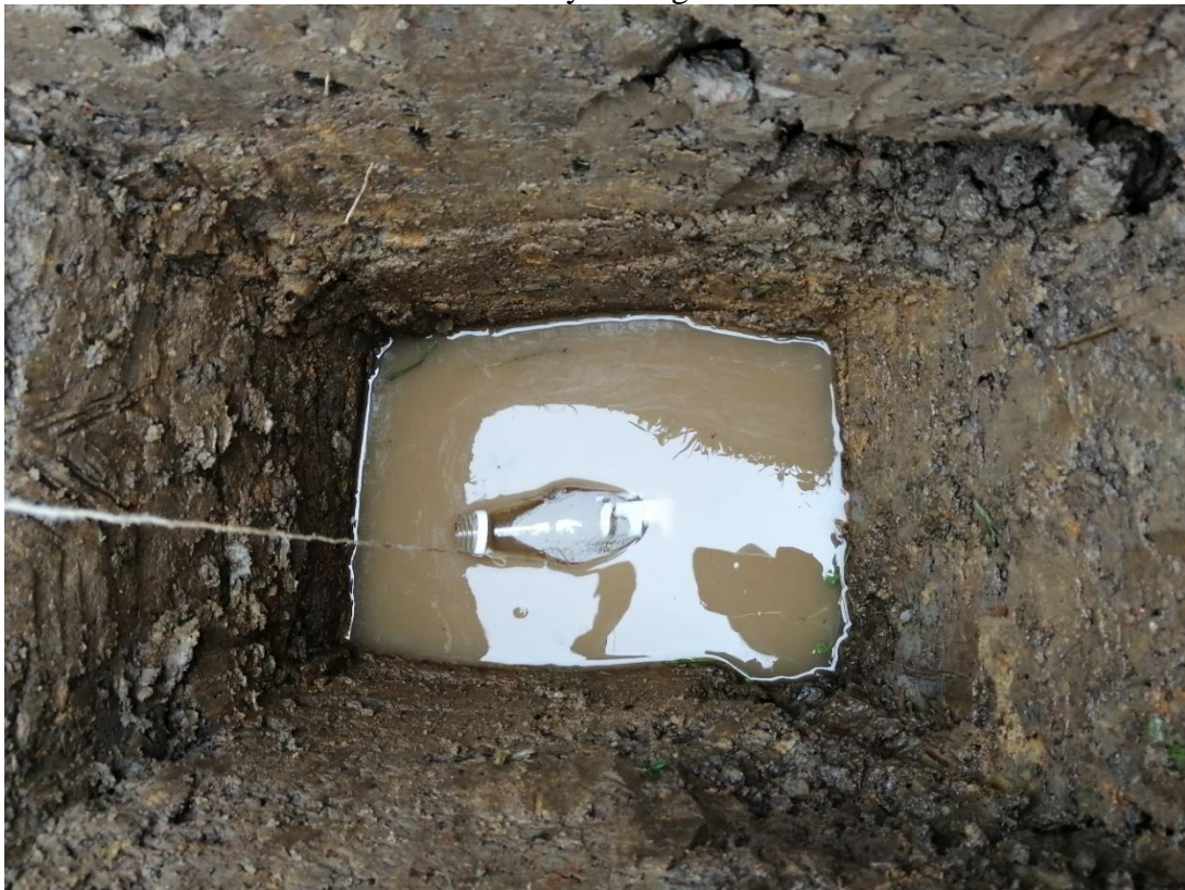
FOTO N° 04: recoleccion de muestra del agua para ser analizado en el laboratorio y definir la cantidad de coliformes fecales y su su grado de contaminacion.
