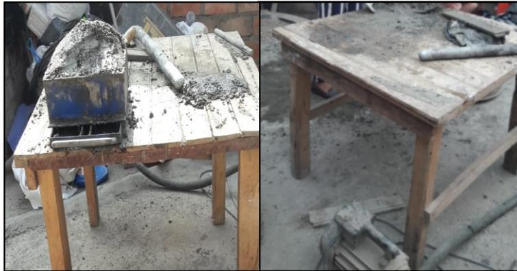
*Figura 16:* Moldes para el diseño de ladrillos de medida 13 x 9 x 24
