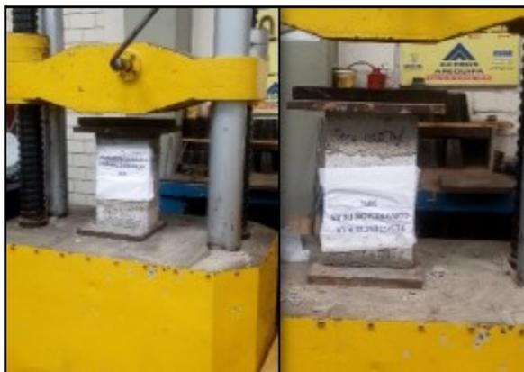
*Figura 48: Ensayo de las Pilas al 0% y 5%*
