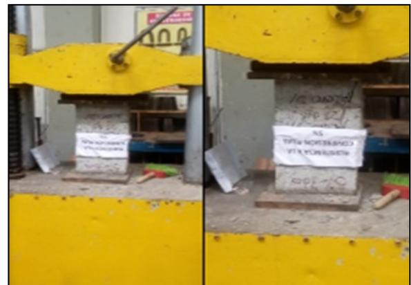
*Figura 49: Ensayo de las Pilas 10% y 15%*
