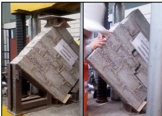
Figura 50: Ensayo Diagonal al 0% y 5%
