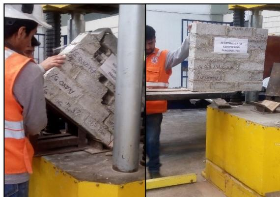
Figura 51: Ensayo Diagonal al 10% y 15%
