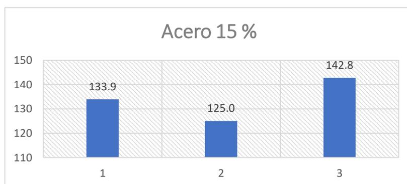
**Figura 42:** Ensayo de Resistencia a la compresión 7 días – 15%.
