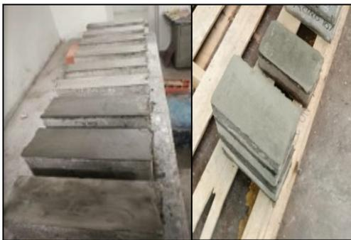
*Figura 33: Capeado de los Ladrillos de 0% y 5%.*
