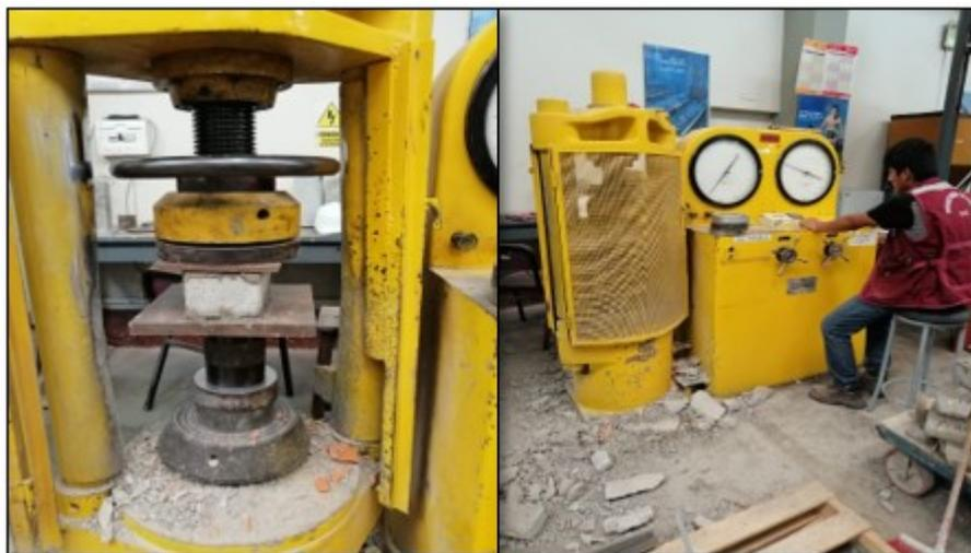
*Figura 35: Ensayo de Resistencia a la compresión por unidad en ladrillos.*
