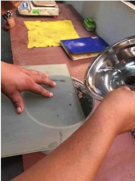
Figura 24. Porcentaje de vacíos, mediante la bomba de vacíos (Rice). Fuente: Elaboración Propia.
