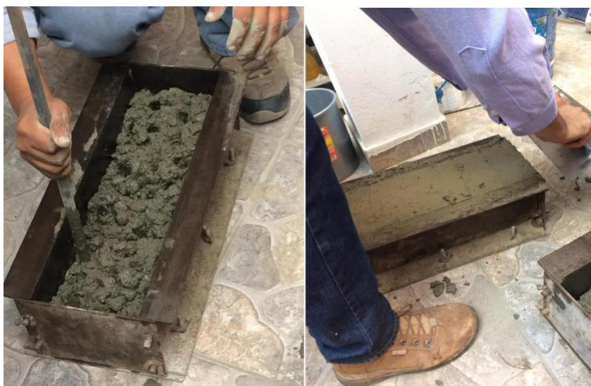
Figura 31. Se utilizaron moldes metal para las vigas de concreto.
