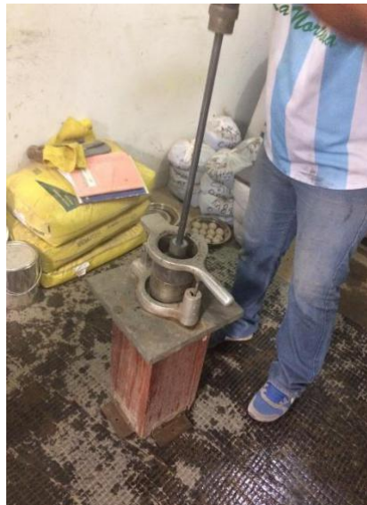
Figura 21. Compactación de briquetas.
