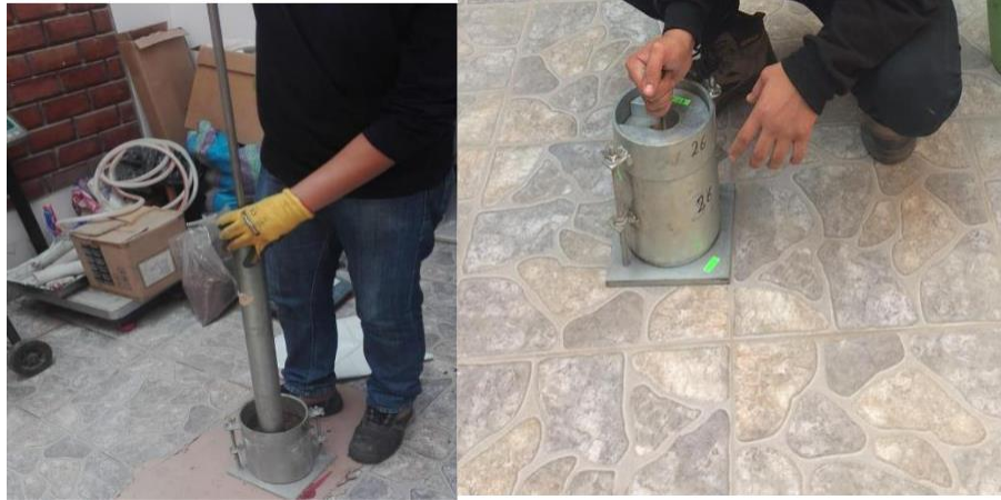
Figura 38. Ensayo de compactación del suelo natural.
