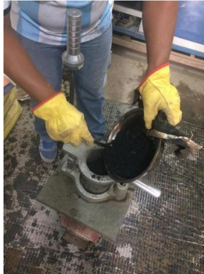
Figura 20. Colocación de la mezcla asfáltica en caliente a los moldes.
