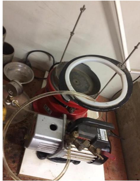
Figura 24. Porcentaje de vacíos, mediante la bomba de vacíos (Rice). Fuente: Elaboración Propia.
