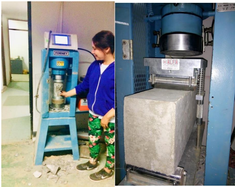
Figura 33. Roturas del concreto, por compresión y deflexión.
