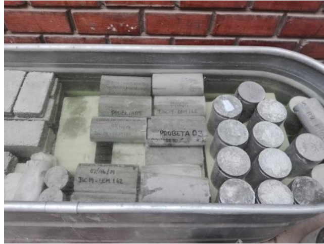
Figura 32. Curado de las probetas de mezcla de concreto.
