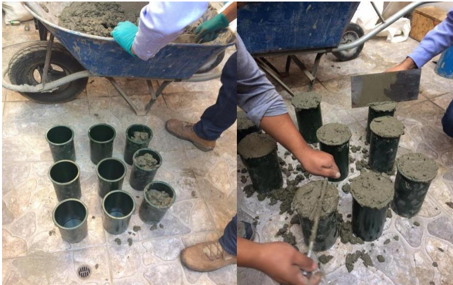
Figura 30. Se utilizaron los moldes plásticos y con ello realizarse las probetas de concreto.
