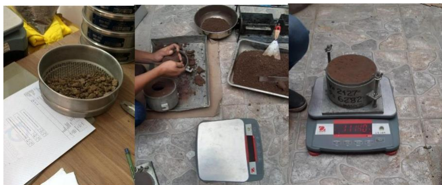
Figura 40. El material pasa por el tamiz \frac{3}{4} , luego pasan a pesarse.
