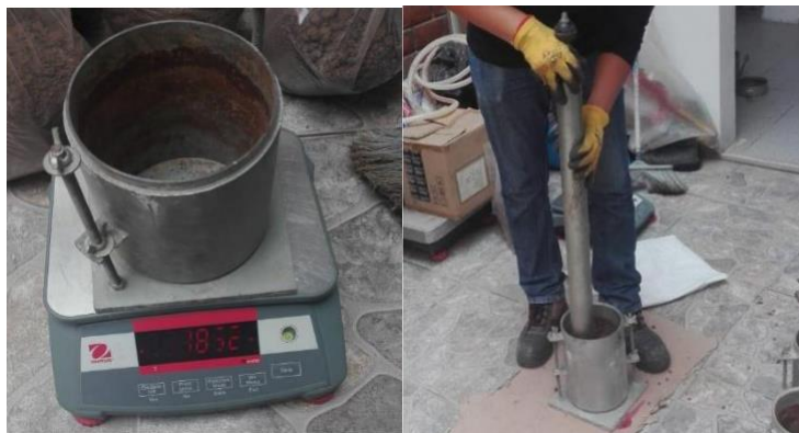
Figura 37. Molde metálico cilíndrico, balanza y pisón metálico.
