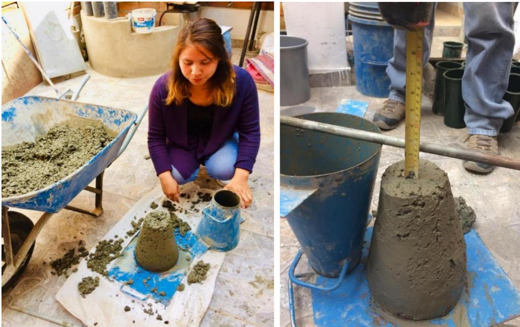
Figura 27. Se halló la trabajabilidad, mediante el ensayo del cono de Abrams, Fuente: Elaboración Propia
