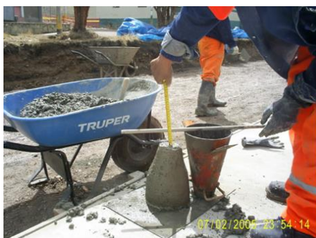
Figura 3. Asentamiento de mezcla de concreto
