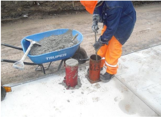
Figura 4. Preparación de probetas cilíndricas
