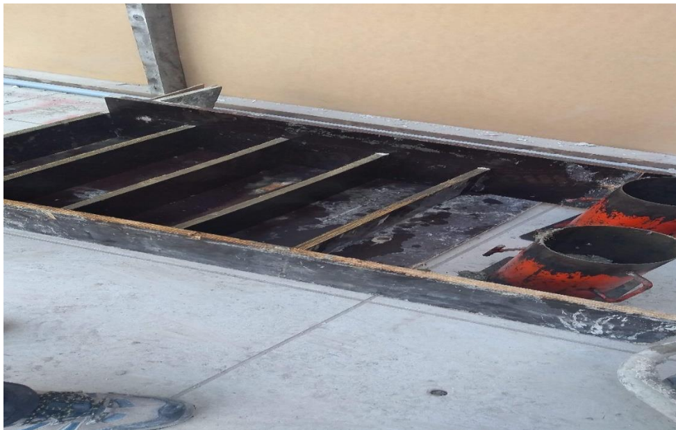
Figura 29: Molde para probetas cilíndricas y vigas Fuente: (propia)
