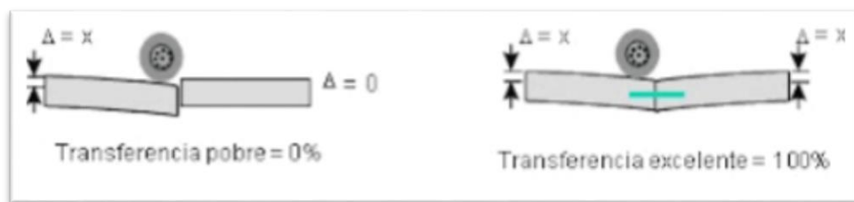
Figura 3: Transmisión de carga en pavimentos
