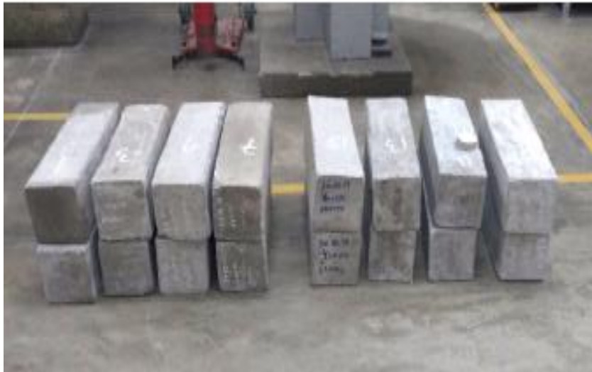
Figura 33: Probetas seleccionadas para el ensayo a flexión Fuente: (propia)
