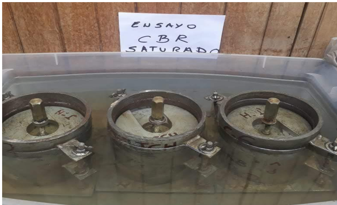
Figura 27: Ensayo de CBR saturado Fuente: (propia)
