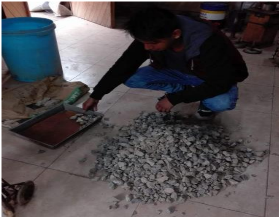
Figura 23: Cuarteo para granulometría de piedra chancada Fuente: (propia)
