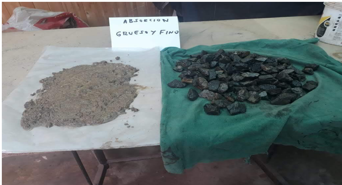
Figura 26: Absorción de agregado grueso y fino Fuente: (propia)
