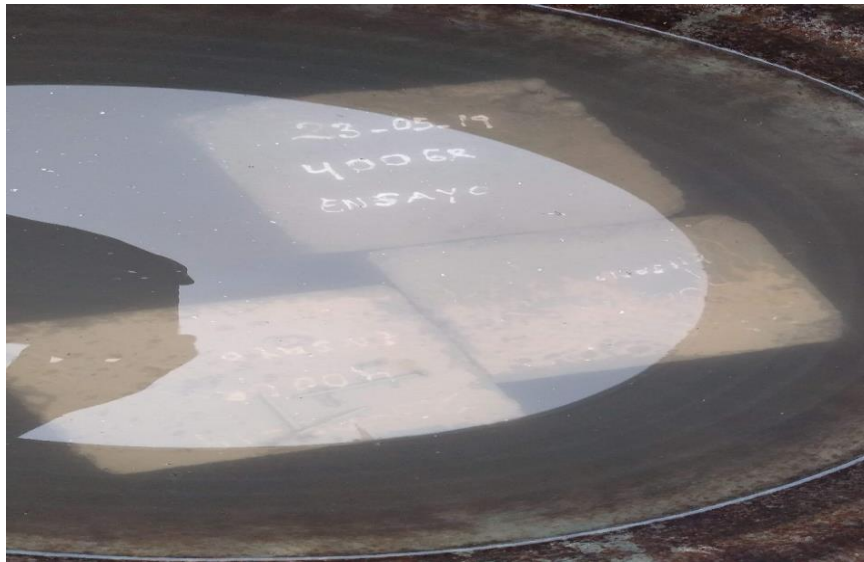
Figura 31: Curado de probetas Fuente: (propia)
