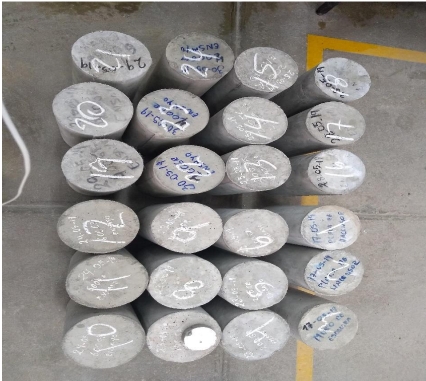
Figura 32: Probetas seleccionadas para el ensayo a compresión Fuente: (propia)
