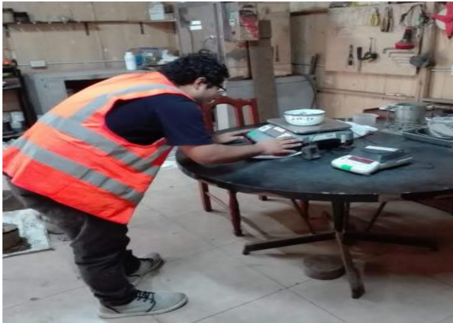
Figura 24: Proceso de pesado material fino Fuente: (propia)
