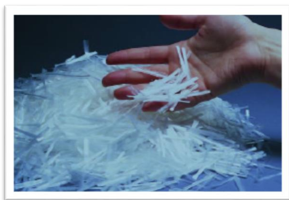
Figura 7: Fibra de polipropileno Fuente: (diseño y control de mezclas de concreto)
