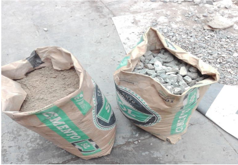
Figura 20: Agregado fino y grueso Fuente: (propia)
