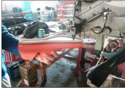
Figura 14. Clavado de palmilla en las hormas.
