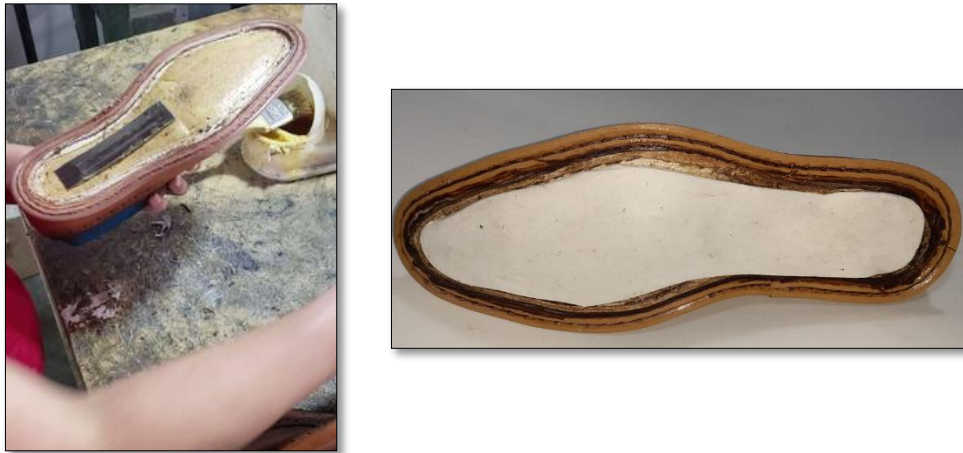
Figura 22. Pegado de cambrillón y relleno.
