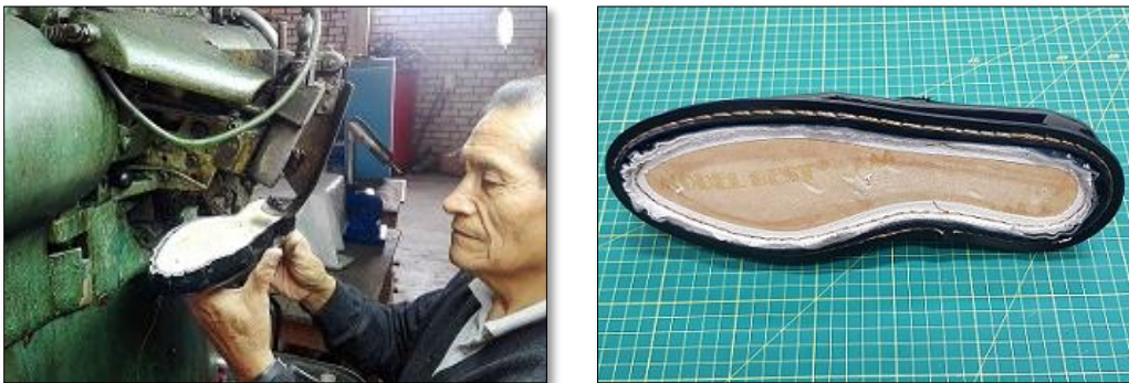
Figura 20. Trincado del Corfan.
