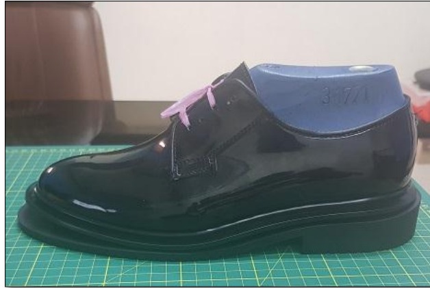
Figura 26. Descalzado de hormas y clavado de taco.
