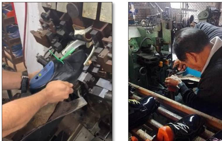
Figura 19. Armado de punta y talón del Corfan.
