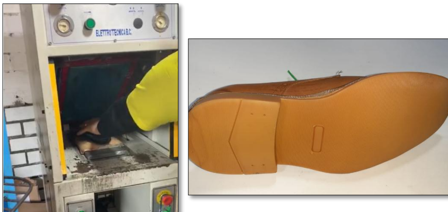
Figura 25. Pegado del taco en el Corfan.
