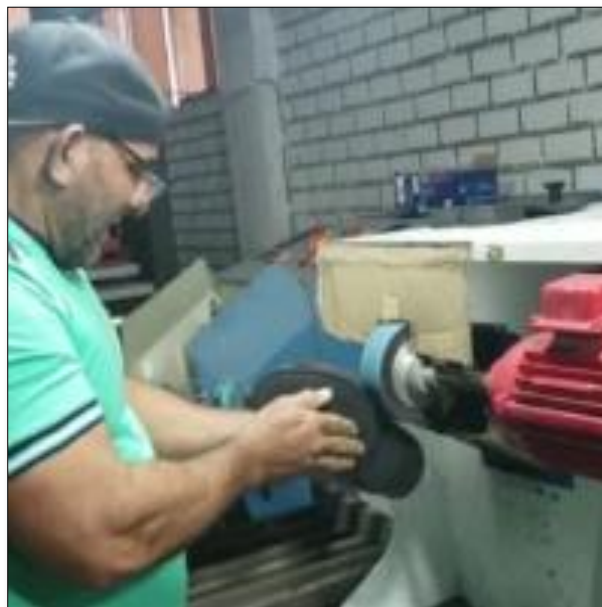
Figura 27. Lijado de calzado corfan.
