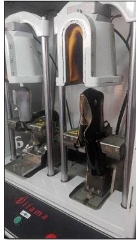
Figura 18. Conformado de Corfan aparado.
