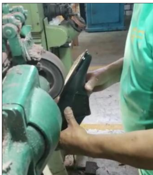
Figura 21. Lijado de cerco.
