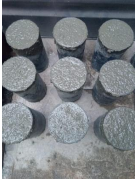
Figura 19. Fraguado de las probetas de concreto
