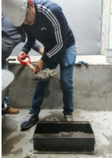
Figura 17. Elaboración de vigas de concreto
