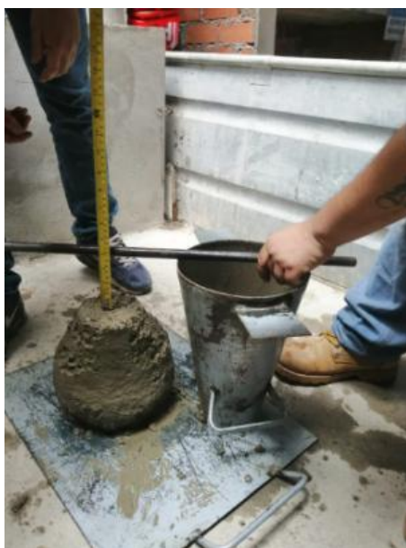
Figura 14. Ensayo de Calidad – SLUMB – Parámetros de la Norma
