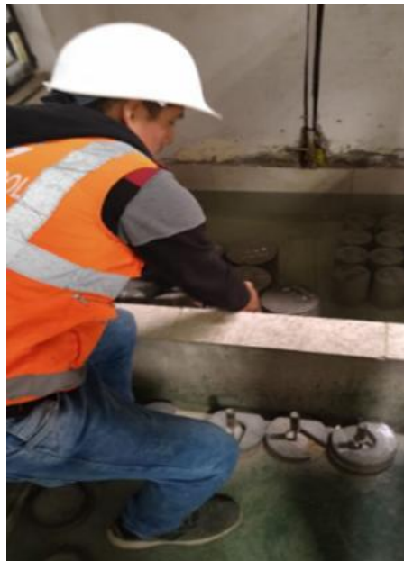
Figura 20. Curado de las probetas de concreto
