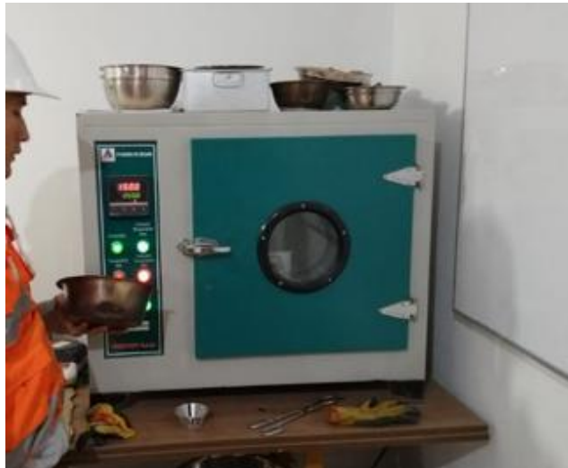
Figura 11. Introducción de agregados al horno
