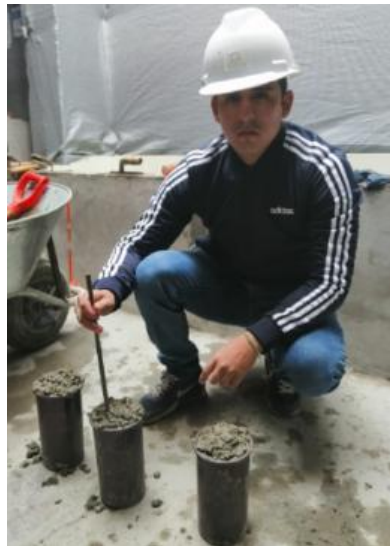
Figura 16. Chuseado con barra de acero liso en la mezcla de concreto
