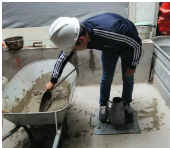
Figura 13. Ensayo de consistencia del concreto - Slump
