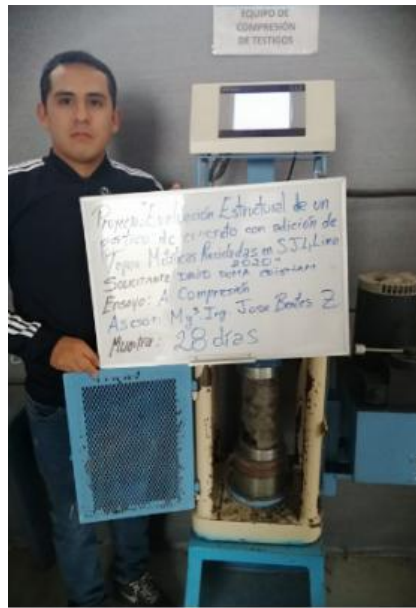
Figura 23. Rotura de probetas a 28 días de fraguado del concreto
