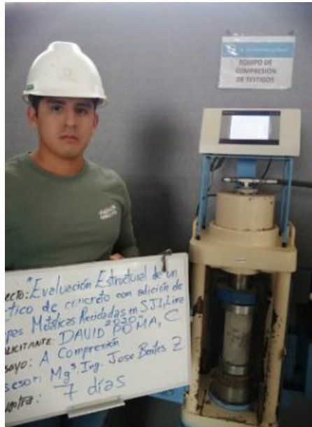
Figura 21. Rotura de probetas a 7 días de fraguado el concreto
