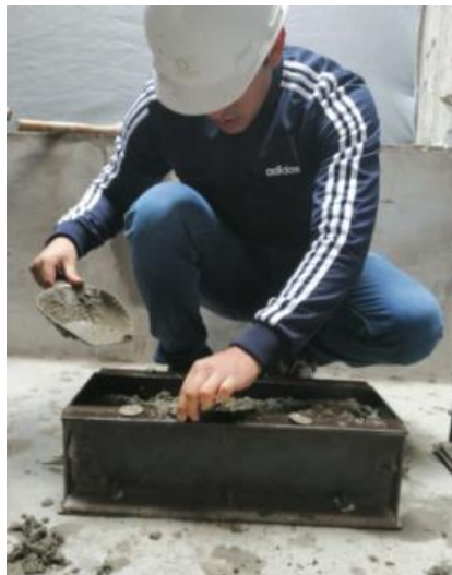
Figura 18. Diseño de mezclas de concreto con tapas recicladas
