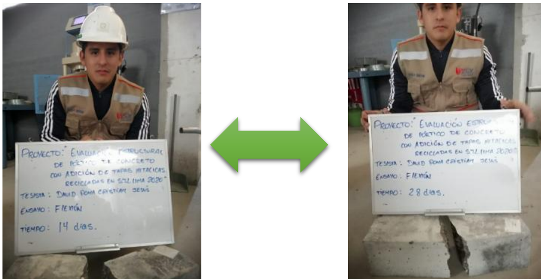
Figura 24. Rotura a 14 y 28 días de vigas de concreto
