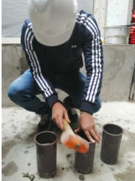
Figura 15. Elaboración de probetas de concreto
