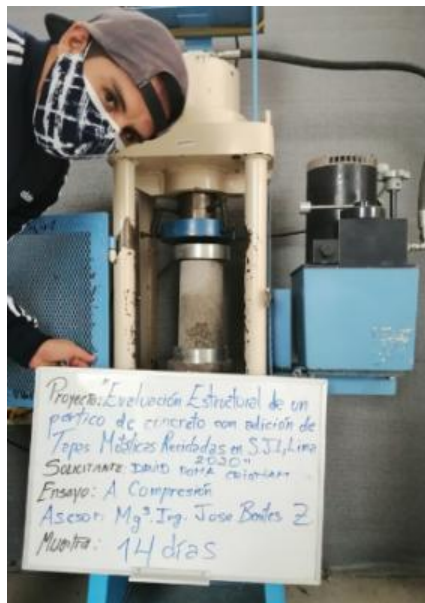
Figura 22. Rotura de probetas a 14 días del fraguado del concreto
