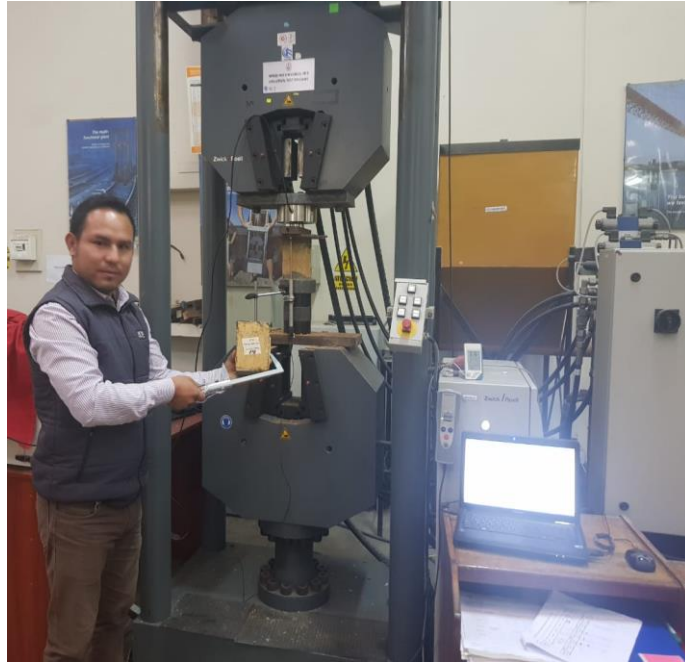
Figura A6.5: Ensayo de módulo de elasticidad en equipo zwich roell con sensor LVDT
