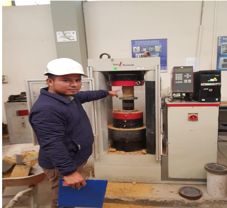
Figura A6.3: Ensayo de compresión del tapial
