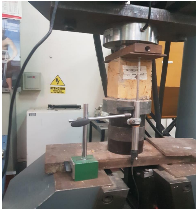
Figura A6.6: Acoplamiento del sensor de deformación LVDT
