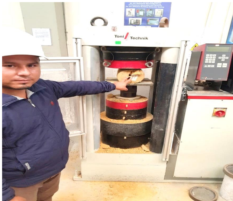
Figura A6.4: Ensayo de tracción indirecta
