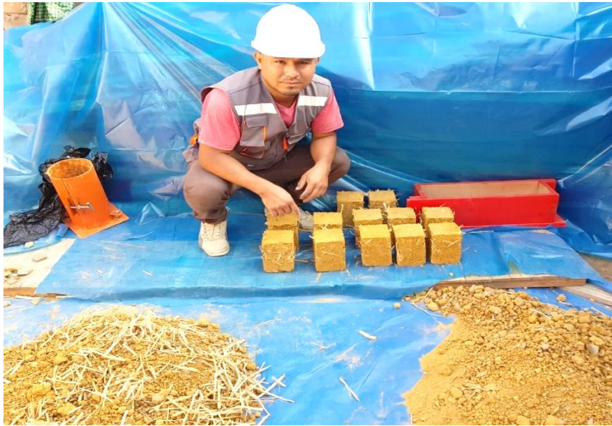
Figura A6.1: Preparación de los especímenes de tapial
