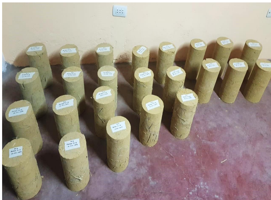
Figura A6.2: Proceso de secado de especímenes
