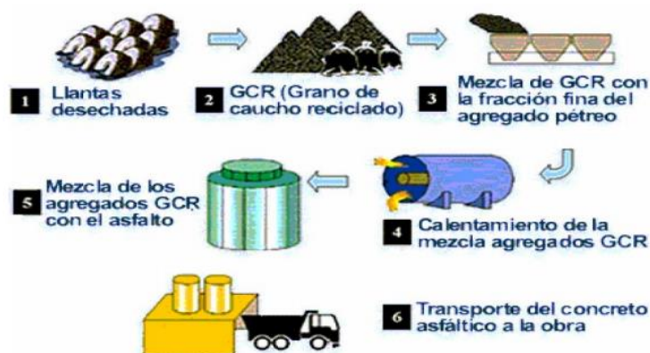
Figura 09. Modificación del asfalto por la vía seca Fuente www.rubberizedasphalt.or
