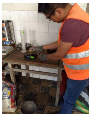
Figura 25. Calibración Copa Casagrande
