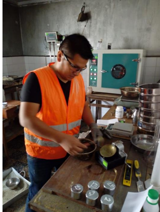
Figura 29. Nivelación de la muestra
