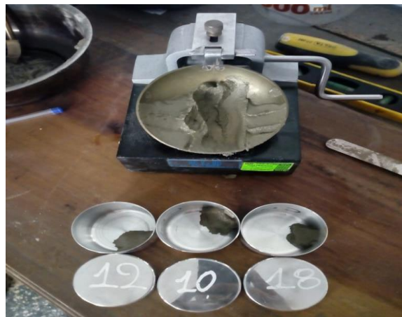
Figura 30. División de la muestra-Copa Casagrande. Fuente: Elaboración propia
