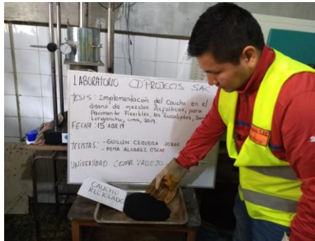
Figura 05. Grano de caucho extraída de las llantas recicladas. Fuente: elaboración propia
