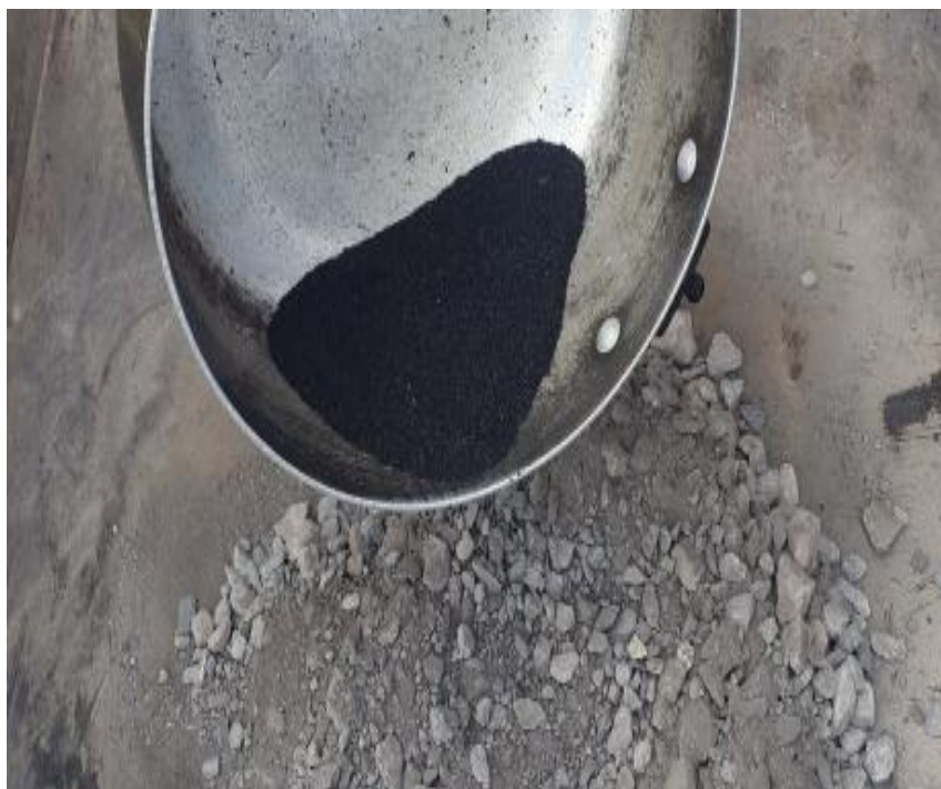
Figura 48. Inserción del caucho en los Agregados. Fuente: elaboración propia
