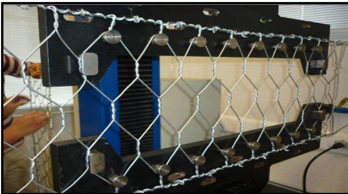
Figura 51: Ensayo de la malla sexagonal a doble torsión
