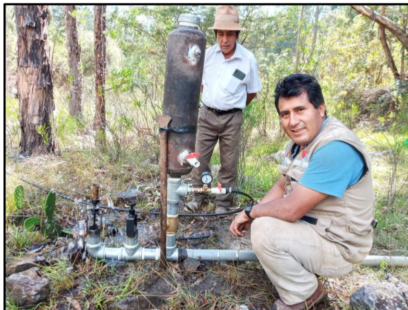
Fotografía 8. bomba de ariete hidráulico trabajando con las válvulas en serie.
