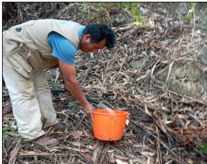
Fotografía 2: Medición del caudal de suministro ( Q_s ).
