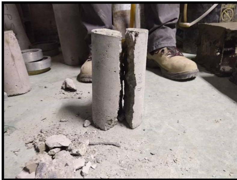
Figura 27: Falla Estructural a la Probeta de Ensayo
