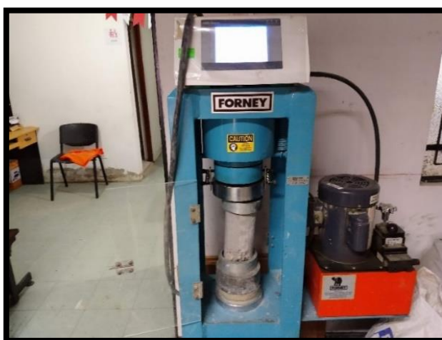
Figura 25: Ensayo de Rotura de Probetas – Diseño Patrón
