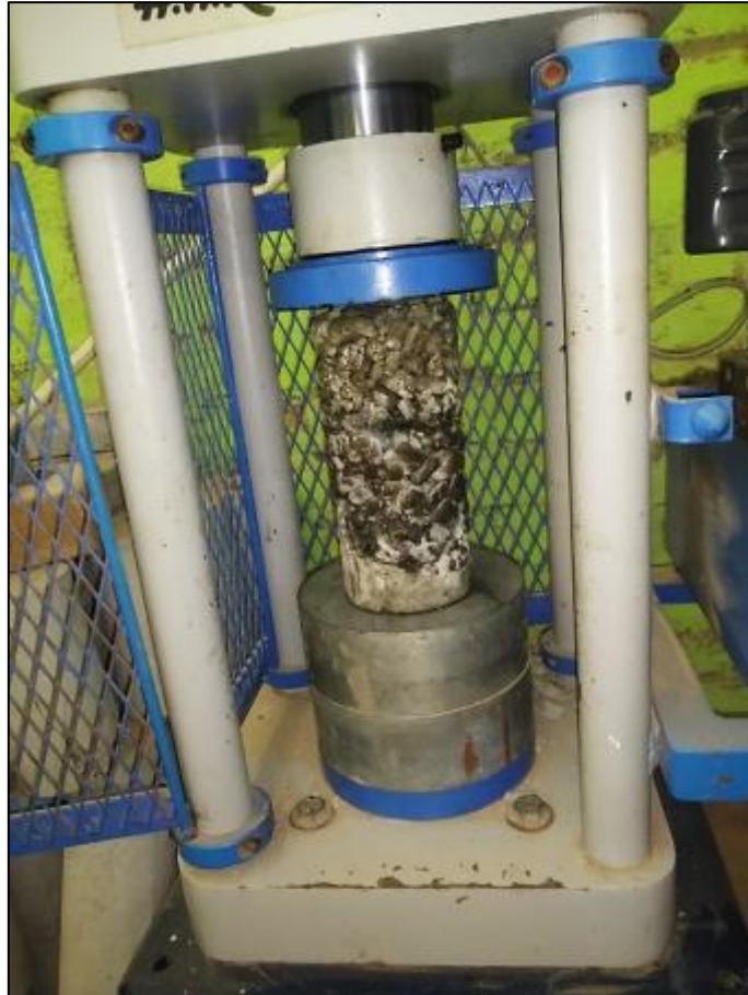
Fuente: Elaboración propia, ensayo de resistencia a la compresión de mezcla de prueba.
