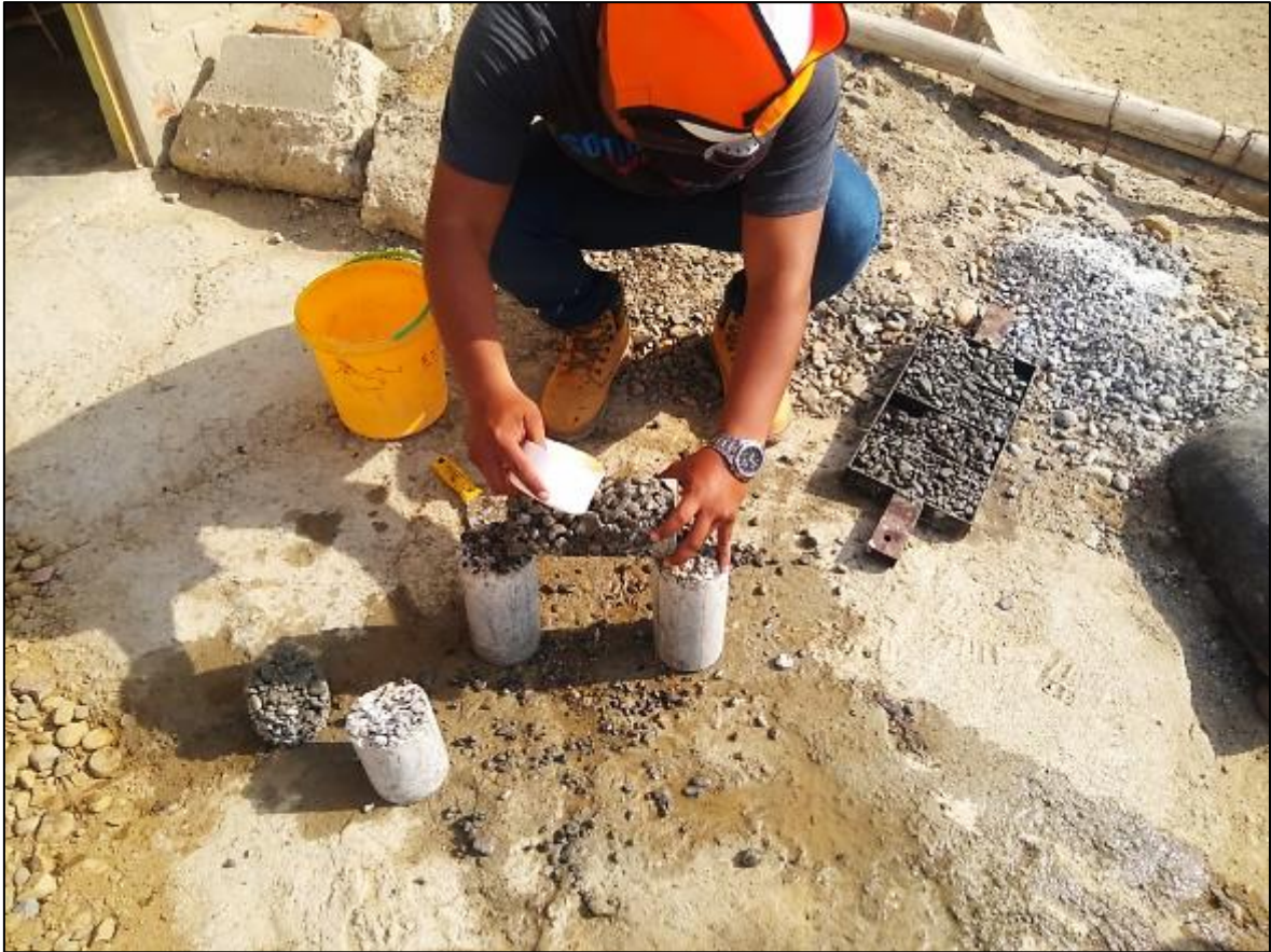
Fuente: Elaboración propia, comprobando la porosidad de la mezcla de prueba.
