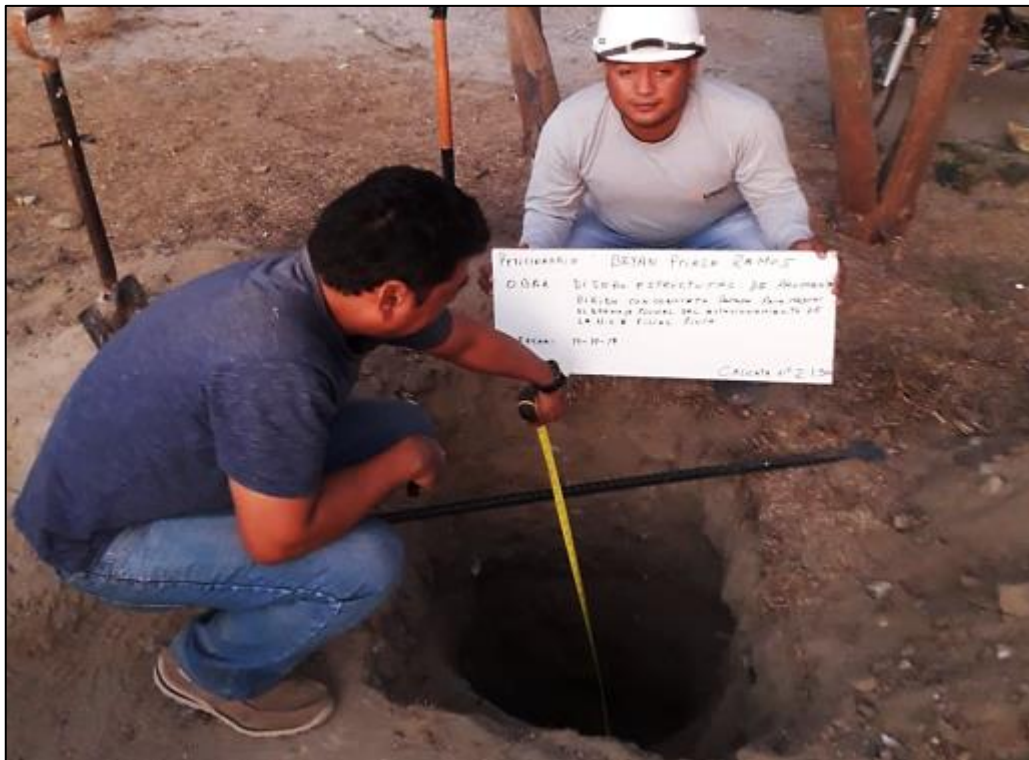
Fuente: Elaboración propia, punto de exploración geotécnica C-2, Prof. 1.50 m.
