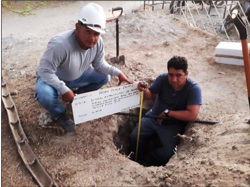
Fuente: Elaboración propia, punto de exploración geotécnica C-1, Prof. 1.50 m.
