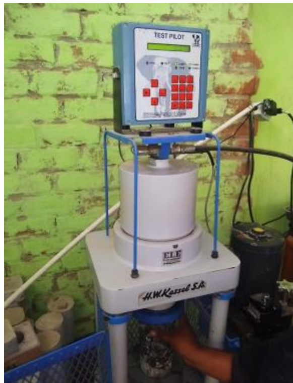
Fuente: Elaboración propia, colocación del espécimen en la prensa de concreto marca ELE.
