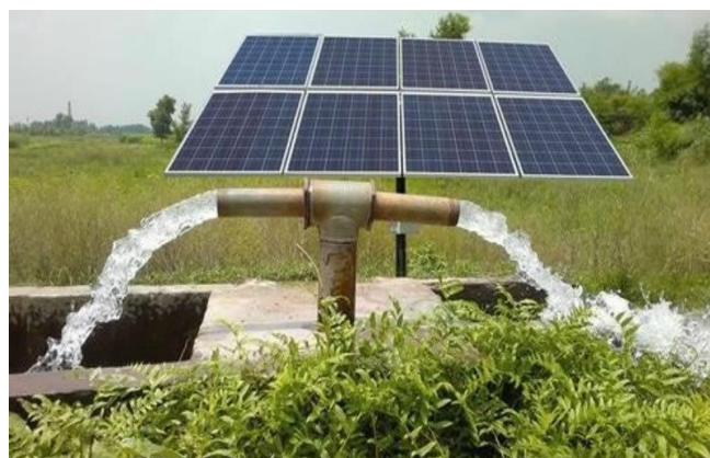
Figura 14. Kit solar de bombeo de agua.
