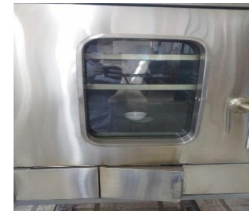
Figura N° 28: Se colocó el suelo en la estufa a 105°C X 60 min para determinar la humedad
