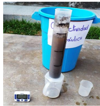
Figura N° 33: Medición de la conductividad hidráulica del suelo
