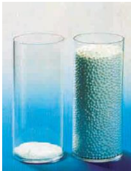
Figura 2. Materia prima antes y después de la etapa de pre expansión.
