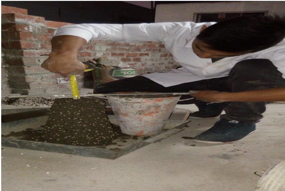
Figura 37. Slump 1.5" del concreto con poliestireno expandido. Fuente: Propia elaboración.
