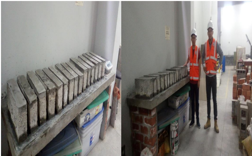
Figura 44. Capping de cemento y yeso (1:2) en los bloques. Fuente: Propia elaboración.
