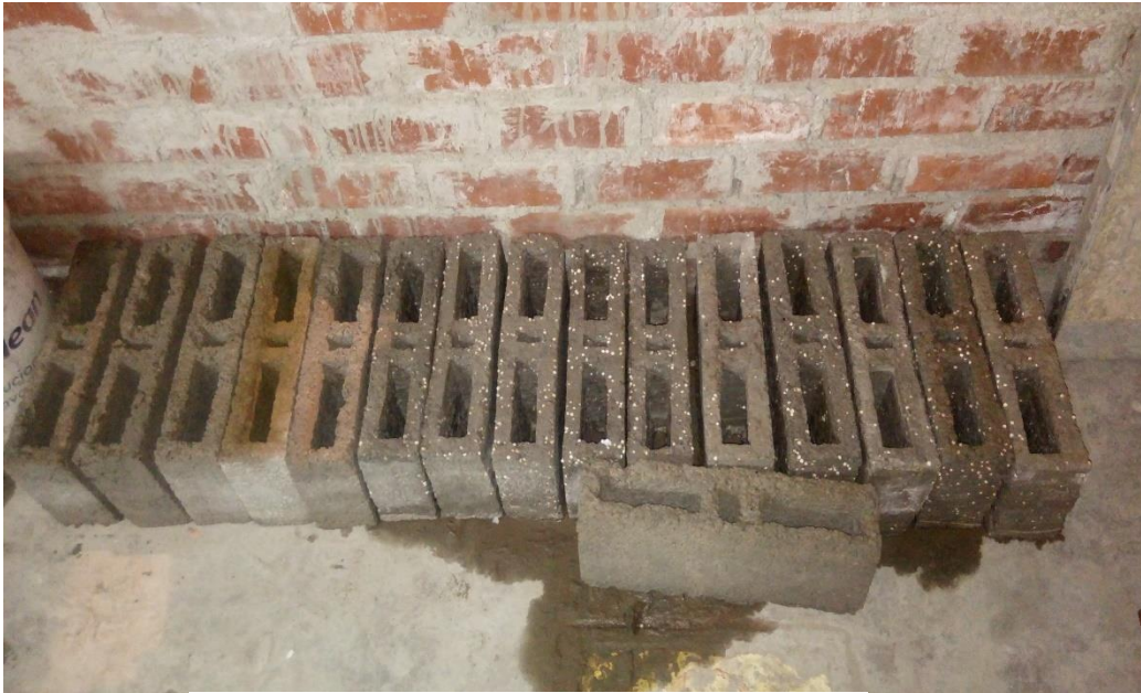
Figura 41. Almacenamiento de los bloques. Fuente: Propia elaboración.
