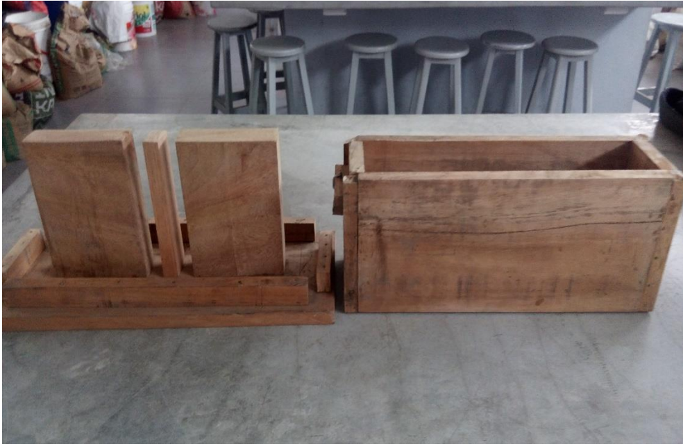
Figura 33. Molde de madera. Fuente: Propia elaboración.
