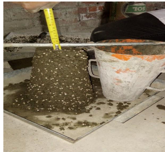
Figura 9. Slump de 1.5" de la mezcla. Fuente: Propia elaboración.
