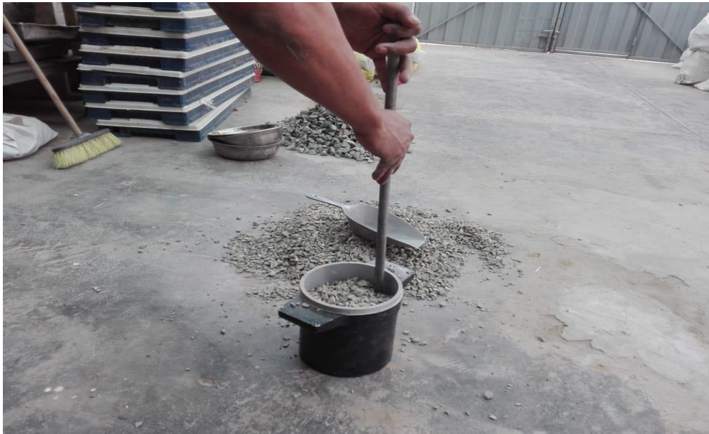
Figura 31. Peso compactado del confitillo. Fuente: Propia elaboración.
