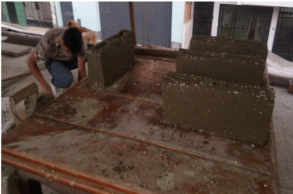
Figura 39. Bloques con poliestireno expandido. Fuente: Propia elaboración.
