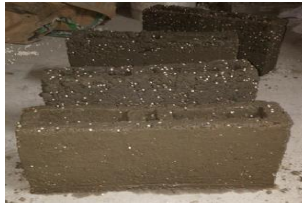
Figura 11. Bloques elaborados con EPS. Fuente: Propia elaboración.
