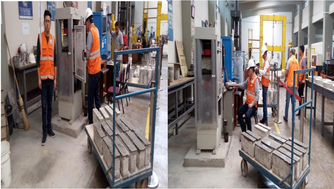
Figura 45. Ensayo a compresión de los bloques de concreto. Fuente: Propia elaboración.
