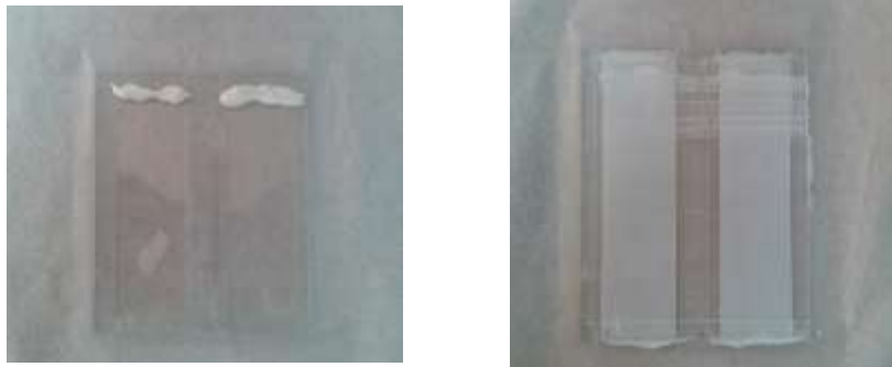
FIGURA 13: Las placas de vidrio con la pasta de TiO 2 Fuente: Fotografía de los autores
